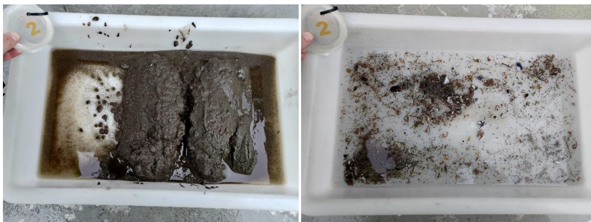
Figur 7: Bilder som viser sedimentet fra stasjon 2 før og etter siling. Sedimentet besto av silt og sand. Det ble registrert fekalier i denne prøven. Foto: Aqua Kompetanse AS.
