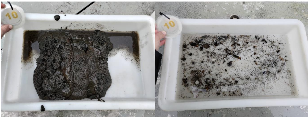
Figur 15: Bilder som viser sedimentet fra stasjon 10 før og etter siling. Sedimentet besto av silt, sand og skjellsand. Foto: Aqua Kompetanse AS.
