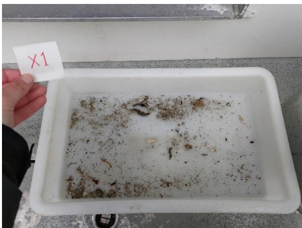
Figur 19: Bilde som viser sedimentet fra stasjon X1 etter siling. Sedimentet besto av silt og leire. Foto: Aqua Kompetanse AS.
