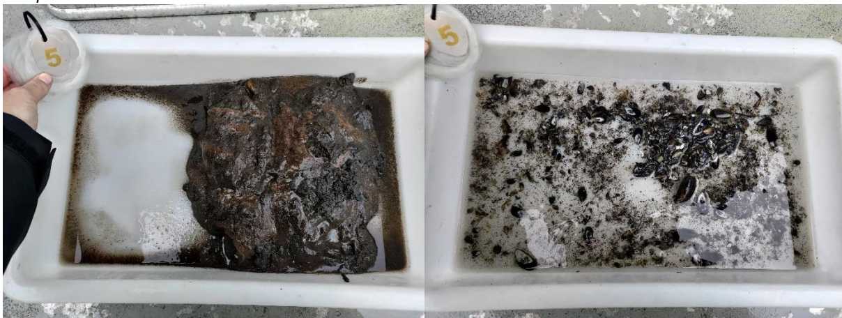
Figur 10: Bilder som viser sedimentet fra stasjon 5 før og etter siling. Sedimentet besto av silt, sand og skjellsand. Det ble registrert fôrrester og fekalier i denne prøven. Foto: Aqua Kompetanse AS.
