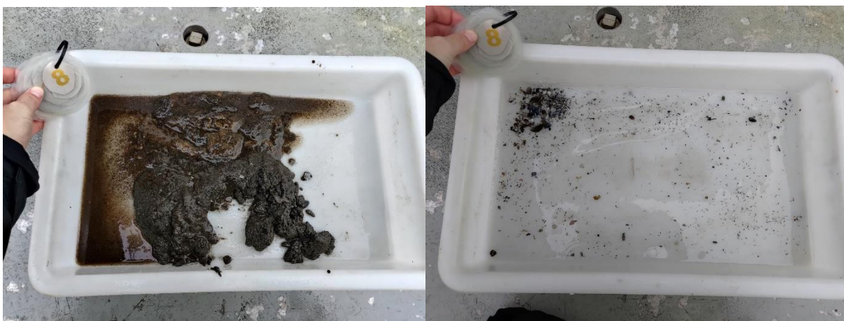
Figur 13: Bilder som viser sedimentet fra stasjon 8 før og etter siling. Sedimentet besto av silt og sand. Det ble registrert fekalier i denne prøven. Foto: Aqua Kompetanse AS.
