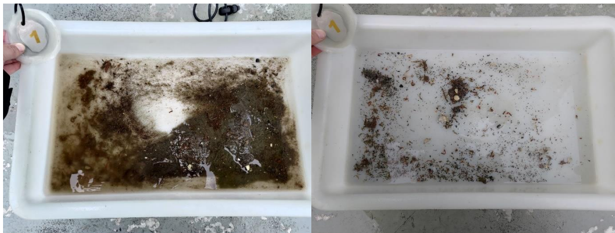
Figur 6: Bilder som viser sedimentet fra stasjon 1 før og etter siling. Sedimentet besto av silt og sand. Det ble registrert fekalier i denne prøven. Foto: Aqua Kompetanse AS.
