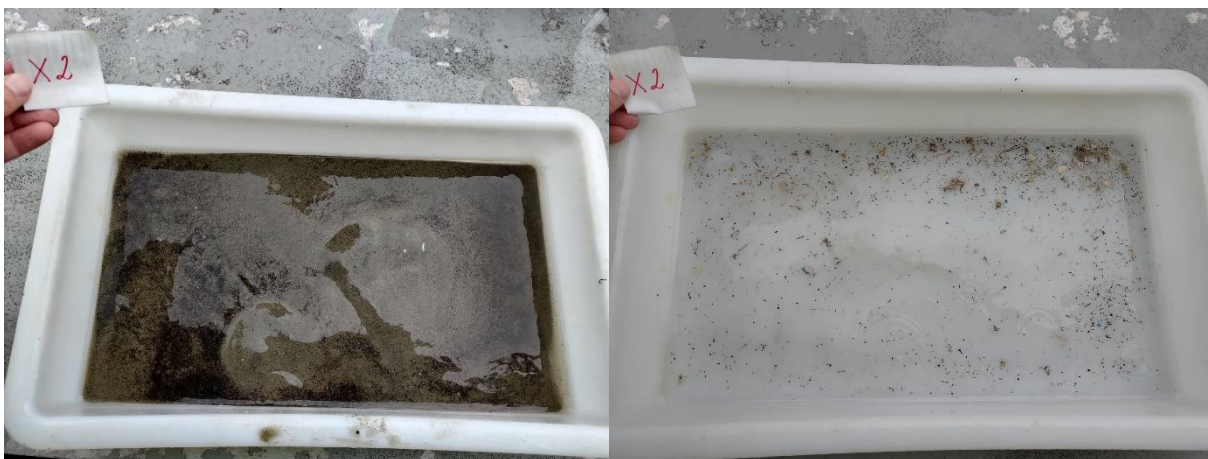
Figur 20: Bilder som viser sedimentet fra stasjon X2 før og etter siling. Sedimentet besto av sand. Foto: Aqua Kompetanse AS.
