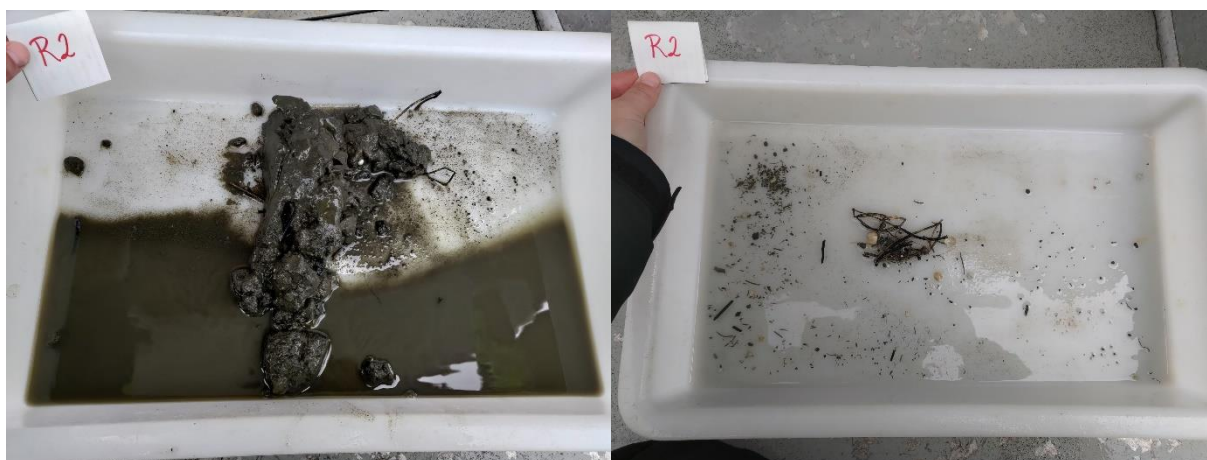
Figur 22: Bilder som viser sedimentet fra stasjon R2 før og etter siling. Sedimentet besto av leire og silt. Foto: Aqua Kompetanse AS.
