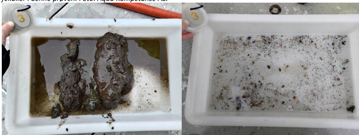
Figur 8: Bilder som viser sedimentet fra stasjon 3 før og etter siling. Sedimentet besto av silt og sand. Foto: Aqua Kompetanse AS.
