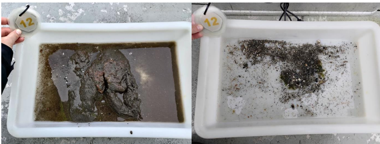
Figur 17: Bilder som viser sedimentet fra stasjon 12 før og etter siling. Sedimentet besto av silt, sand og skjellsand. Det ble registrert fekalier i denne prøven. Foto: Aqua Kompetanse AS.
