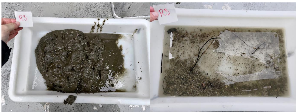
Figur 23: Bilder som viser sedimentet fra stasjon R3 før og etter siling. Sedimentet besto av silt, leire og skjellsand. Foto: Aqua Kompetanse AS.
