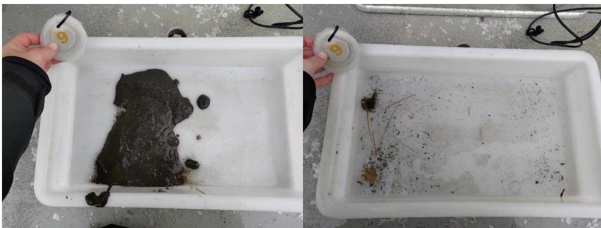
Figur 14: Bilder som viser sedimentet fra stasjon 9 før og etter siling. Sedimentet besto av silt og sand. Foto: Aqua Kompetanse AS.
