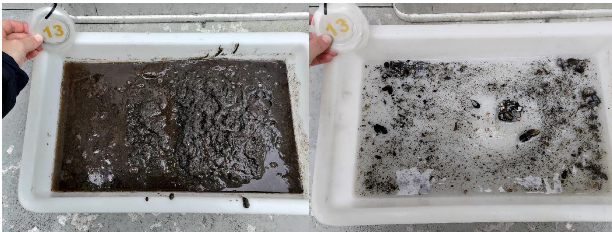
Figur 18: Bilder som viser sedimentet fra stasjon 13 før og etter siling. Sedimentet besto av silt og sand. Det ble registrert fekalier i denne prøven. Foto: Aqua Kompetanse AS.
