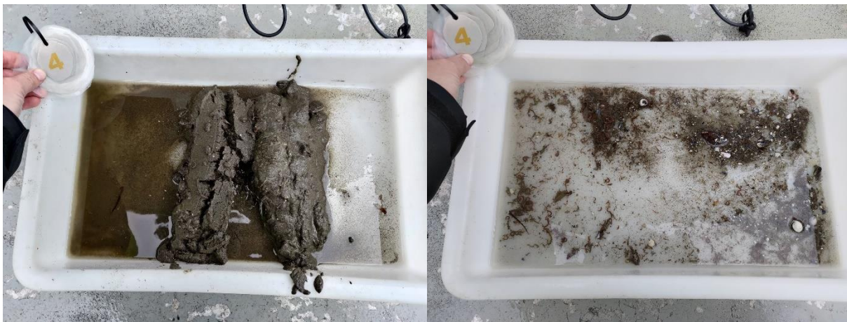
Figur 9: Bilder som viser sedimentet fra stasjon 4 før og etter siling. Sedimentet besto av silt og sand. Foto: Aqua Kompetanse AS.
