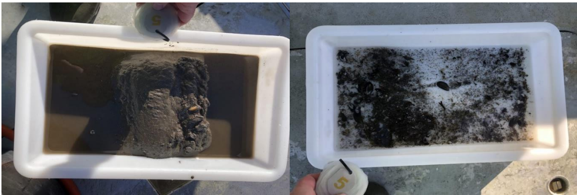
Figur 5: Bilder som viser sedimentet fra stasjon 5 før og etter siling. Sedimentet besto av av silt og grus. Foto: Aqua Kompetanse AS.
