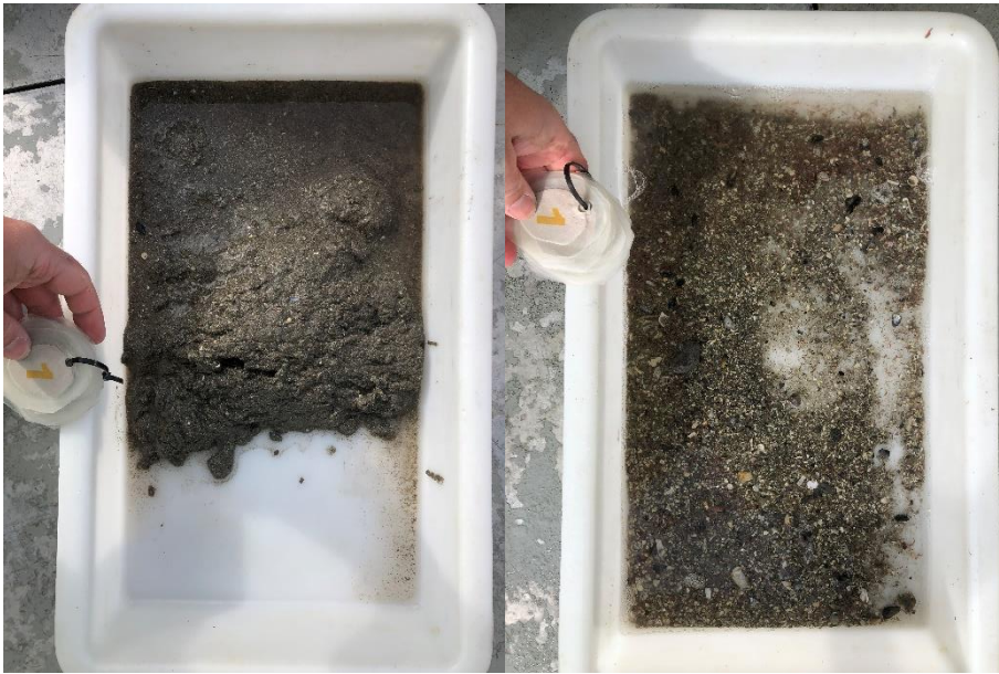
Figur 1: Bilder som viser sedimentet fra stasjon 1 før og etter siling. Sedimentet besto av sand, grus og skjellsand. Foto: Aqua Kompetanse AS.
