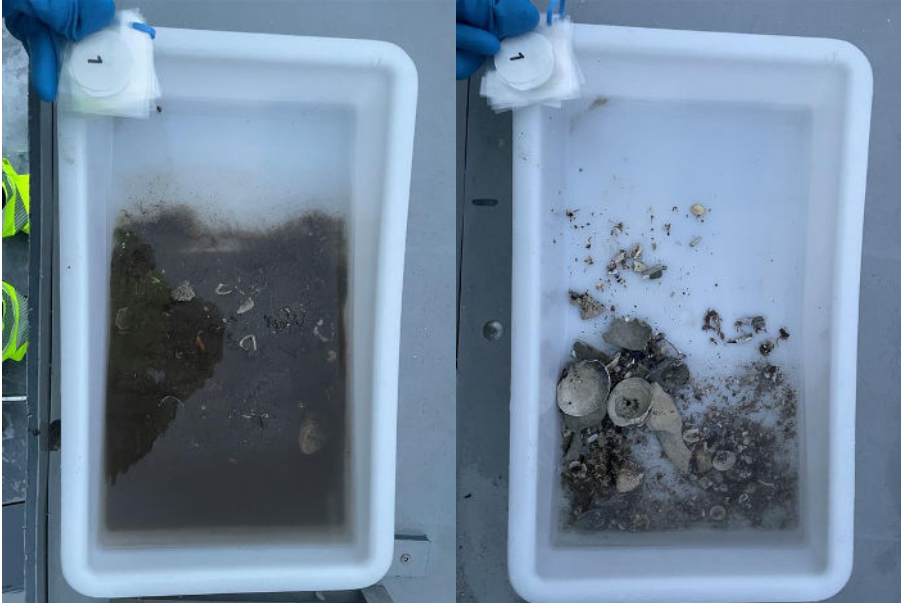
Figur 1: Bilder som viser sedimentet fra stasjon 1 før og etter siling. Sedimentet bestod av silt og noe sand. Det ble registrert fôr og fekalier ved stasjonen. Foto: Aqua Kompetanse AS.
