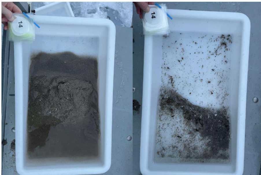
Figur 14: Bilder som viser sedimentet fra stasjon 14 før og etter siling. Sedimentet bestod av silt og noe sand. Foto: Aqua Kompetanse AS.
