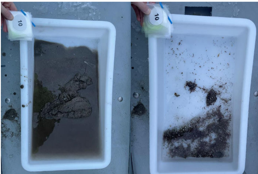
Figur 10: Bilder som viser sedimentet fra stasjon 10 før og etter siling. Sedimentet besto av silt og noe sand. Foto: Aqua Kompetanse AS.
