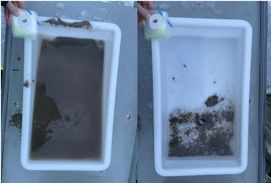
Figur 9: Bilder som viser sedimentet fra stasjon 9 før og etter siling. Sedimentet besto av silt og noe sand. Foto: Aqua Kompetanse AS.
