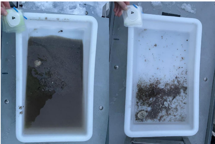
Figur 4: Bilder som viser sedimentet fra stasjon 4 før og etter siling. Sedimentet besto av silt og sand. Foto: Aqua Kompetanse AS.
