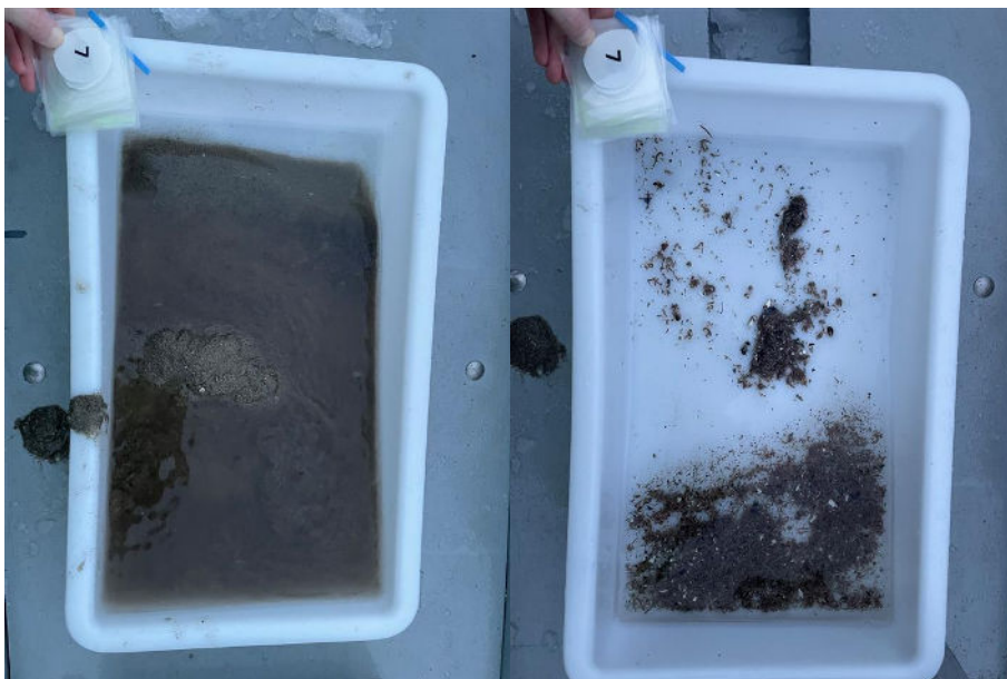
Figur 7: Bilder som viser sedimentet fra stasjon 7 før og etter siling. Sedimentet besto av silt og sand. Foto: Aqua Kompetanse AS.
