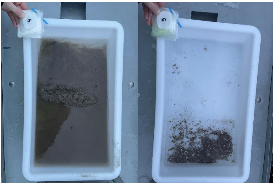
Figur 6: Bilder som viser sedimentet fra stasjon 6 før og etter siling. Sedimentet besto av silt og sand. Foto: Aqua Kompetanse AS.
