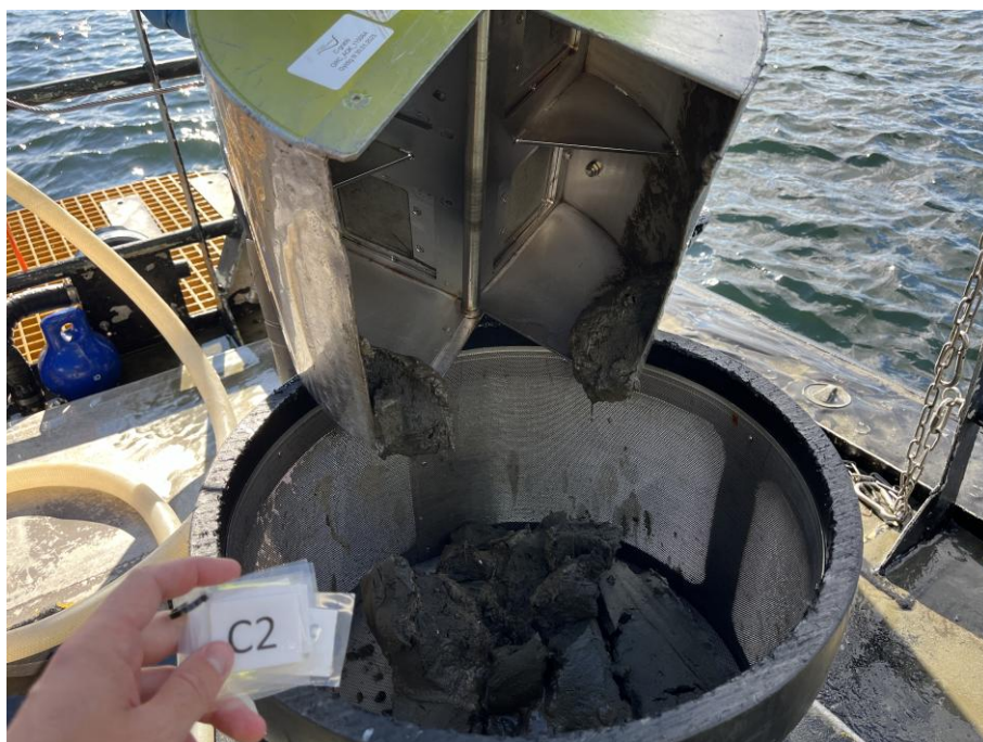
Figur 9-2: Bilde av sedimentet ved C2. Sedimentet besto av sand og silt. Foto: Aqua Kompetanse AS.
