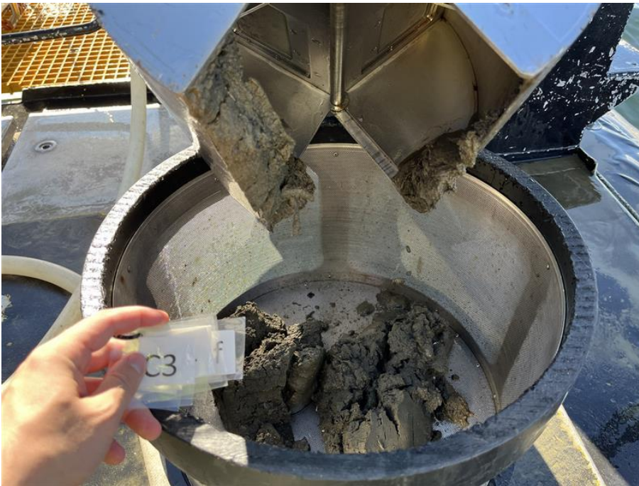
Figur 9-3: Bilde av sedimentet ved C3. Sedimentet besto av sand og silt. Foto: Aqua Kompetanse AS.
