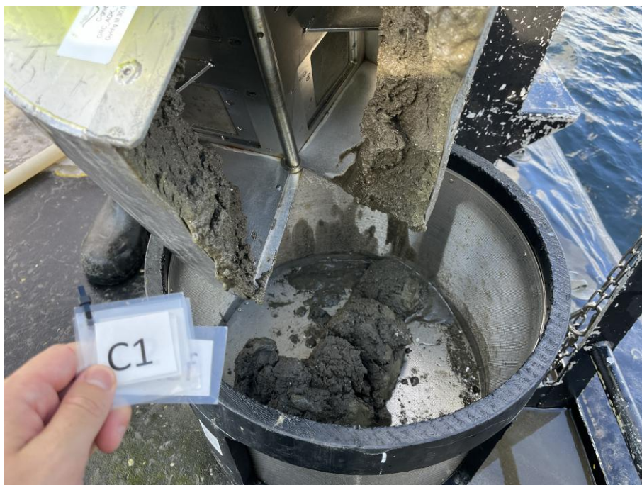
Figur 9-1: Bilde av sedimentet ved C1. Sedimentet besto av sand og silt. Foto: Aqua Kompetanse AS.
