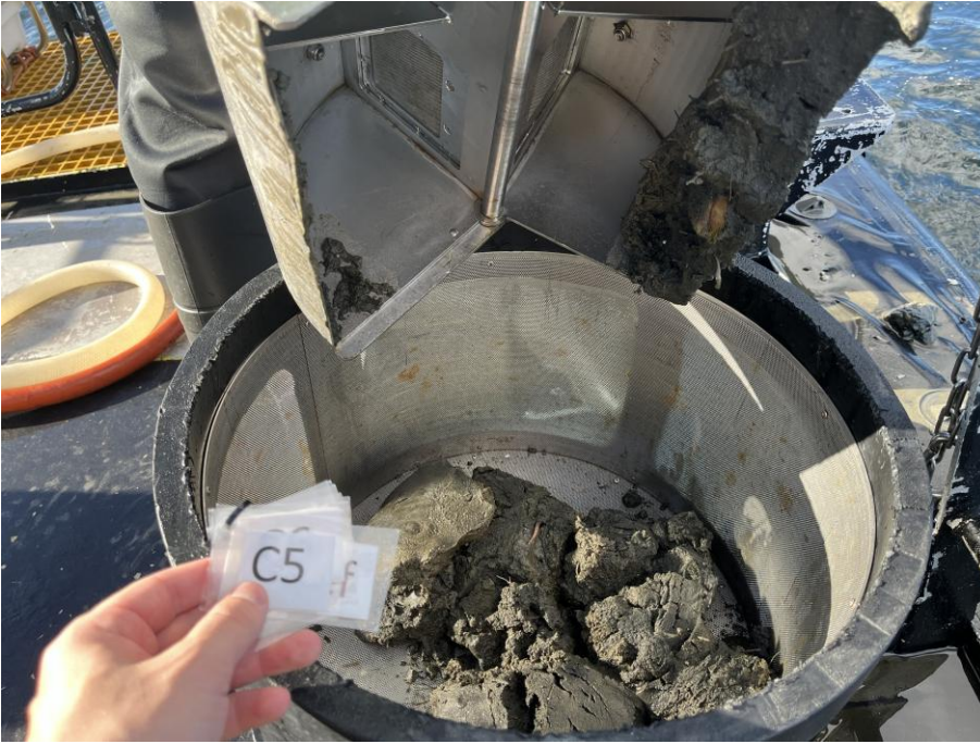
Figur 9-5: Bilde av sedimentet ved C5. Sedimentet besto av sand og silt. Foto: Aqua Kompetanse AS.
