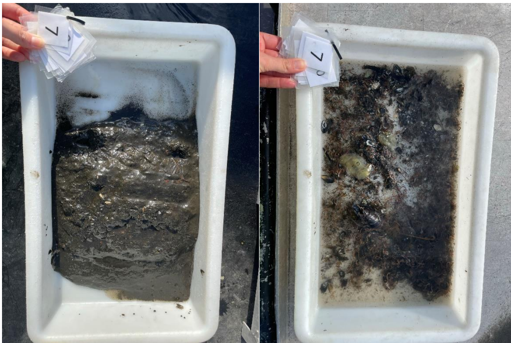
Figur 6: Bilder som viser sedimentet fra stasjon 7. Sedimentet besto av silt og noe sand. Foto: Aqua Kompetanse AS.
