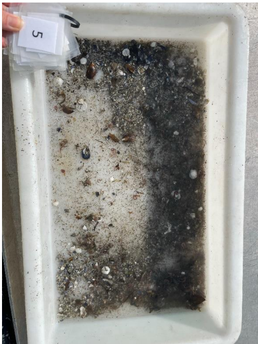
Figur 4: Bilder som viser sedimentet fra stasjon 5 etter siling. Sedimentet besto av silt, og noe skjellsand og sand. Bilde før siling ble avglemt i felt. Foto: Aqua Kompetanse AS.
