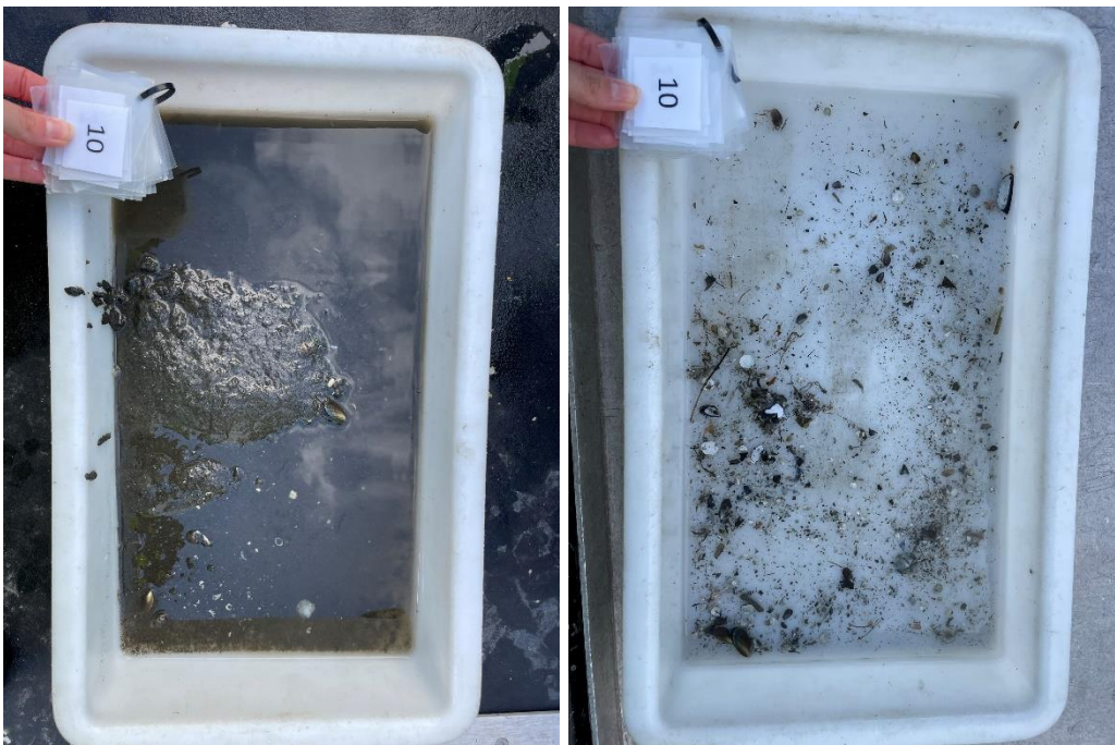
Figur 8: Bilder som viser sedimentet fra stasjon 10 før og etter siling. Sedimentet besto av silt og noe sand. Foto: Aqua Kompetanse AS.
