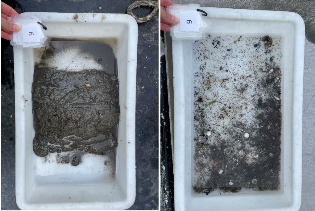
Figur 5: Bilder som viser sedimentet fra stasjon 6. Sedimentet besto av silt og sand. Foto: Aqua Kompetanse AS.
