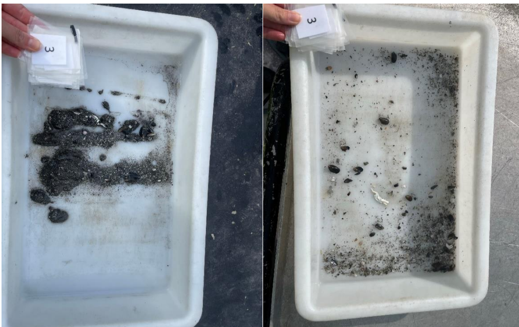
Figur 2: Bilder som viser sedimentet fra stasjon 3 før og etter siling. Sedimentet besto av silt og sand på fjellbunn. Foto: Aqua Kompetanse AS.
