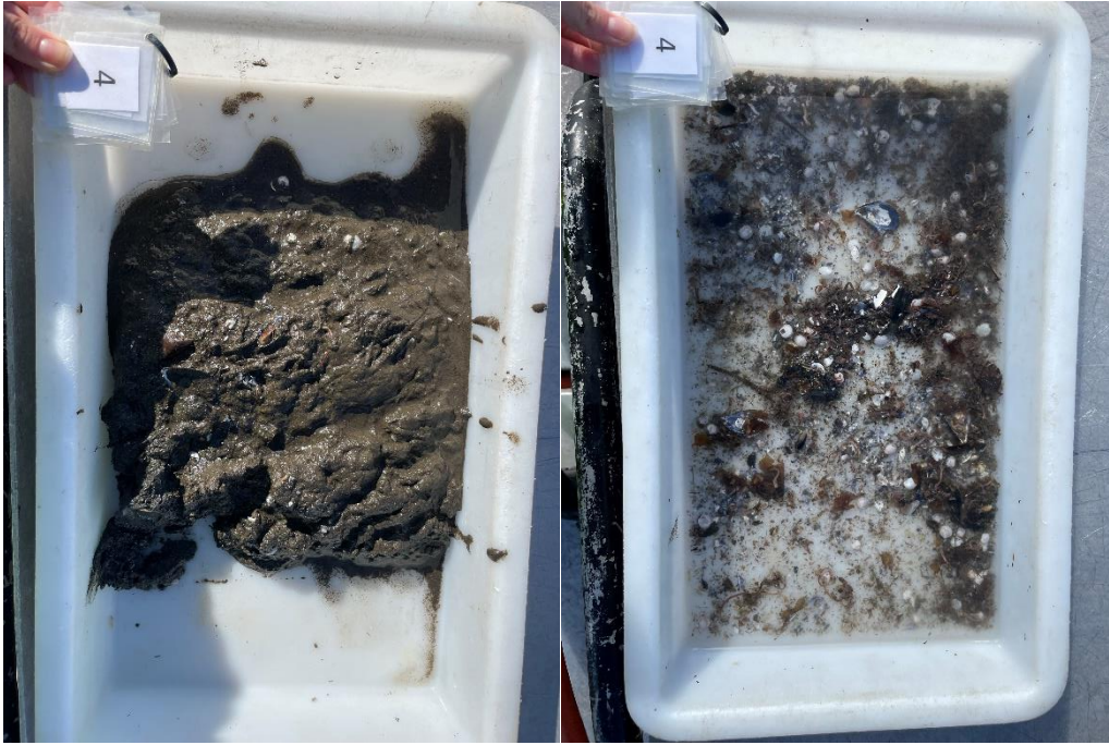
Figur 3: Bilder som viser sedimentet fra stasjon 4 før og etter siling. Sedimentet besto av silt og sand. Foto: Aqua Kompetanse AS.
