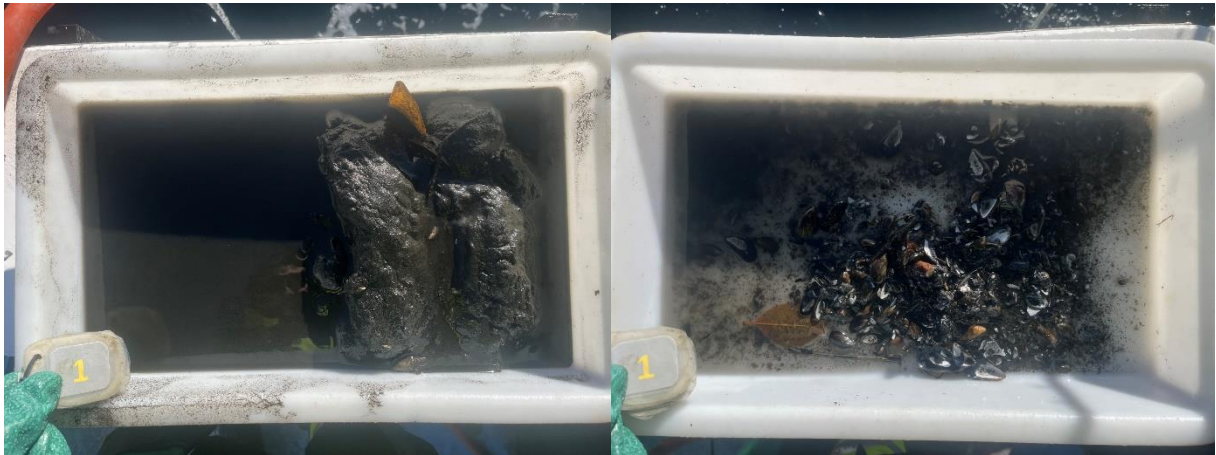
Figur 1: Bilder som viser sedimentet fra stasjon 1 før og etter siling. Foto: Aqua Kompetanse AS.
