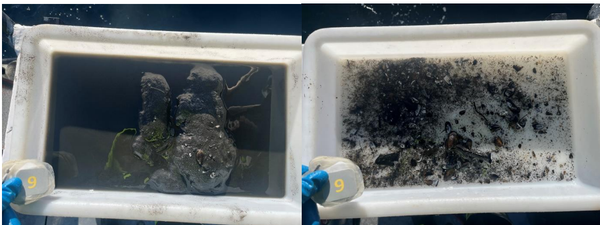
Figur 9: Bilder som viser sedimentet fra stasjon 9 før og etter siling. Foto: Aqua Kompetanse AS.
