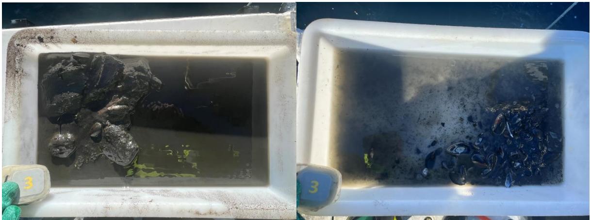
Figur 3: Bilder som viser sedimentet fra stasjon 3 før og etter siling. Foto: Aqua Kompetanse AS.
