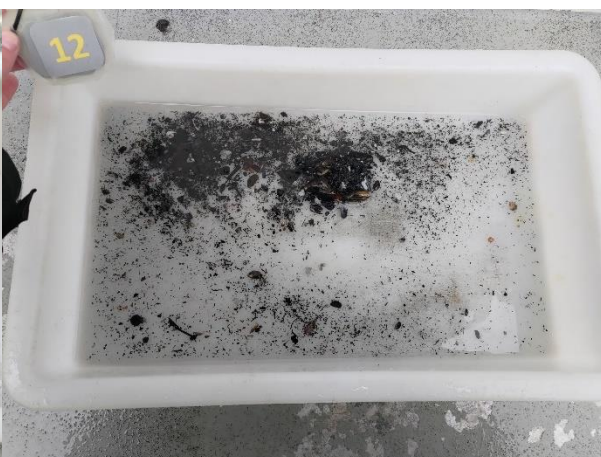
Figur 17: Bilder som viser sedimentet fra stasjon 12 før og etter siling. Sedimentet besto av sand og silt. Foto: Aqua Kompetanse AS.
