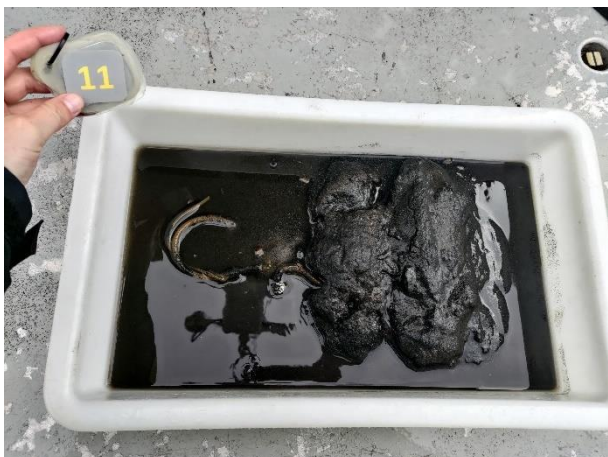
Figur 16: Bilder som viser sedimentet fra stasjon 11 før og etter siling. Sedimentet besto av silt og sand. Foto: Aqua Kompetanse AS.
