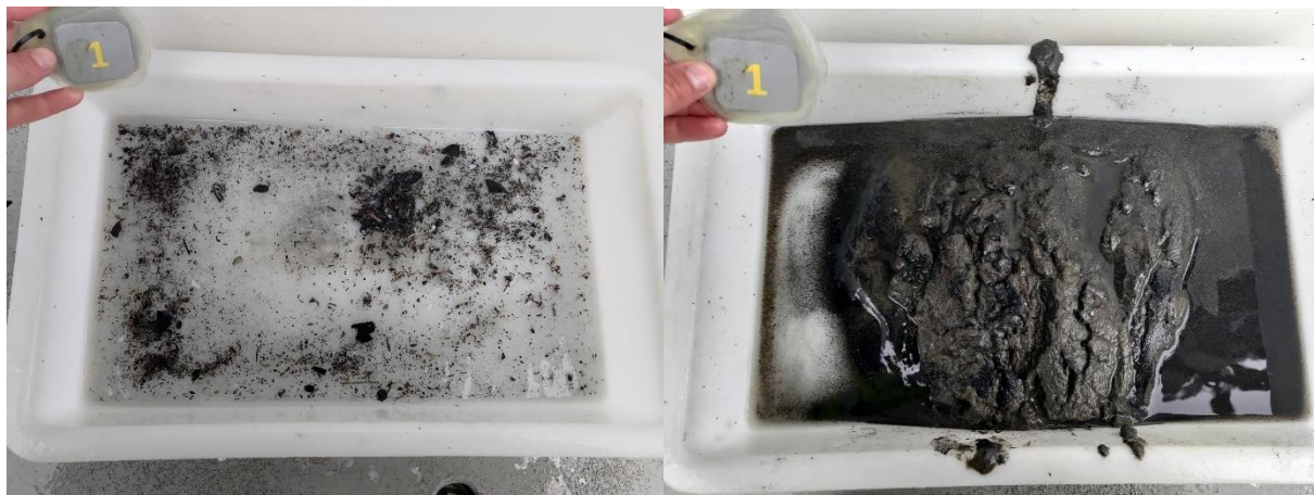
Figur 6: Bilder som viser sedimentet fra stasjon 1 før og etter siling. Sedimentet besto av sand og silt. Foto: Aqua Kompetanse AS.
