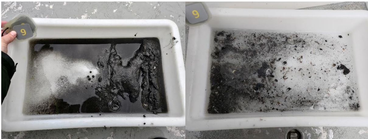
Figur 14: Bilder som viser sedimentet fra stasjon 9 før og etter siling. Sedimentet besto av silt og sand. Foto: Aqua Kompetanse AS.
