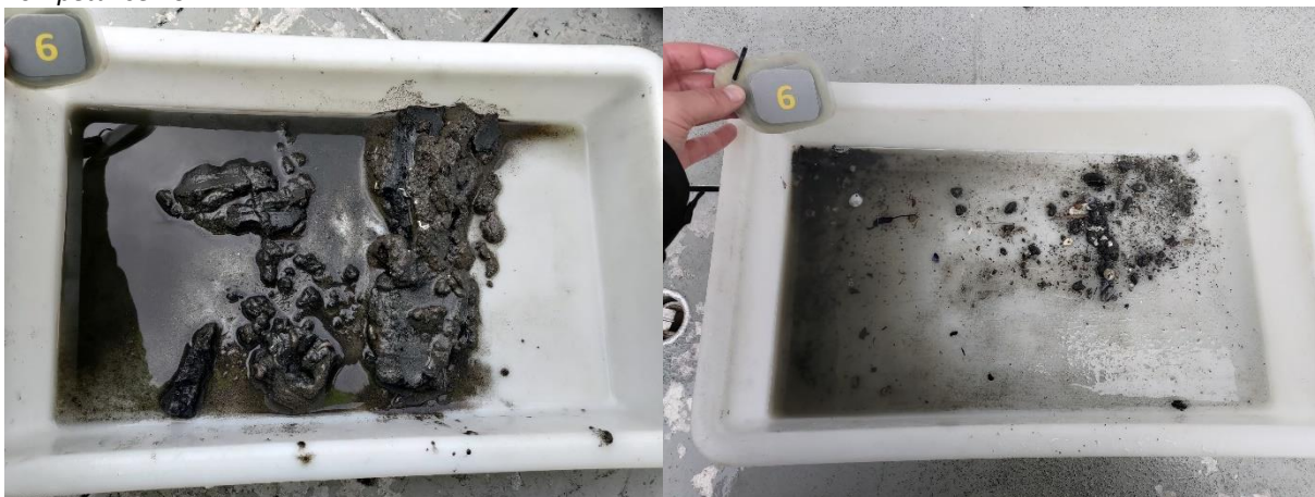
Figur 11: Bilder som viser sedimentet fra stasjon 6 før og etter siling. Sedimentet besto av leire og sand. Foto: Aqua Kompetanse AS.
