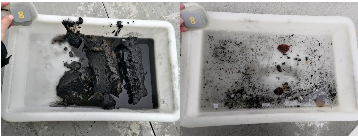
Figur 13: Bilder som viser sedimentet fra stasjon 8 før og etter siling. Sedimentet besto av leire, silt og sand. Foto: Aqua Kompetanse AS.
