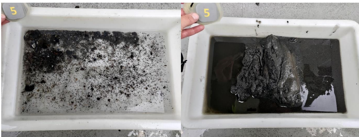
Figur 10: Bilder som viser sedimentet fra stasjon 5 før og etter siling. Sedimentet besto av sand og silt. Foto: Aqua Kompetanse AS.
