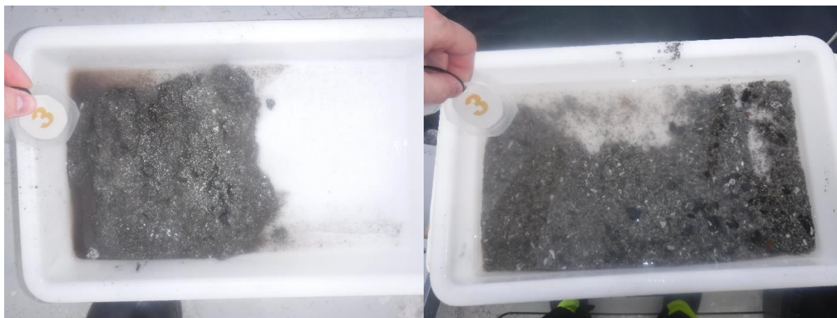
Figur 8: Bilder som viser sedimentet fra stasjon 3 før og etter siling. Sedimentet besto av skjellsand, grus og silt. Det ble registrert fekalier i denne prøven. Foto: Aqua Kompetanse AS.
