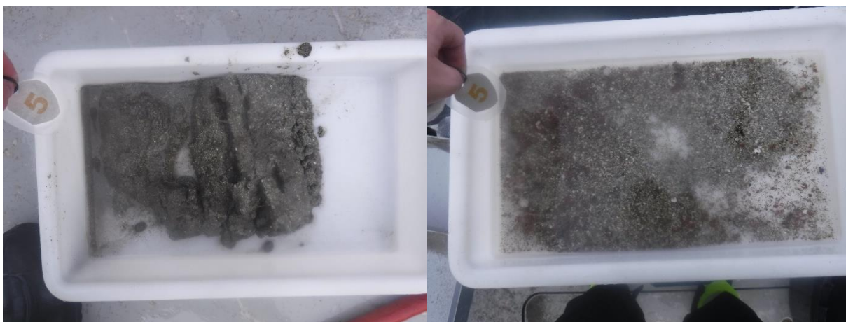
Figur 10: Bilder som viser sedimentet fra stasjon 5 før og etter siling. Sedimentet besto av skjellsand, sand og silt. Foto: Aqua Kompetanse AS.
