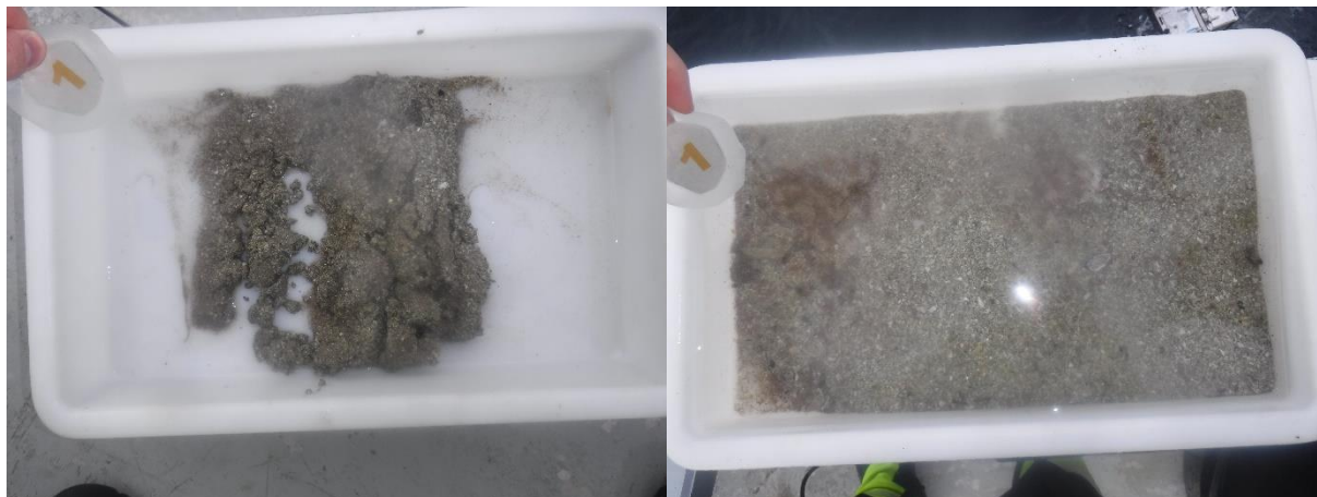
Figur 6: Bilder som viser sedimentet fra stasjon 1 før og etter siling. Sedimentet besto av skjellsand og sand. Foto: Aqua Kompetanse AS.
