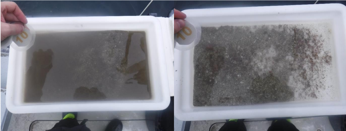
Figur 15: Bilder som viser sedimentet fra stasjon 10 før og etter siling. Sedimentet besto av skjellsand, silt og grus. Foto: Aqua Kompetanse AS.
