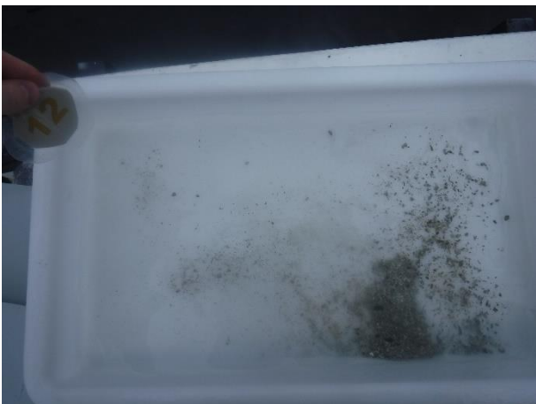
Figur 17: Bilde som viser sedimentet fra stasjon 12. Sedimentet besto av skjellsand på fjellbunn. Foto: Aqua Kompetanse AS.
