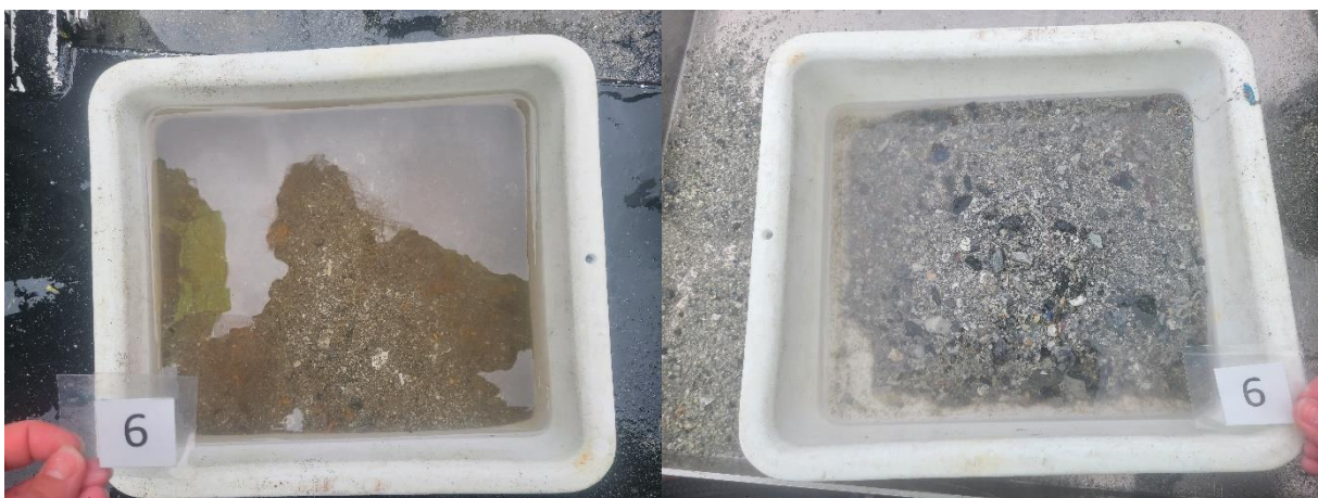
Figur 6: Bilder som viser sedimentet fra stasjon 6. Sedimentet besto av skjellsand og grus. Foto: Aqua Kompetanse AS.
