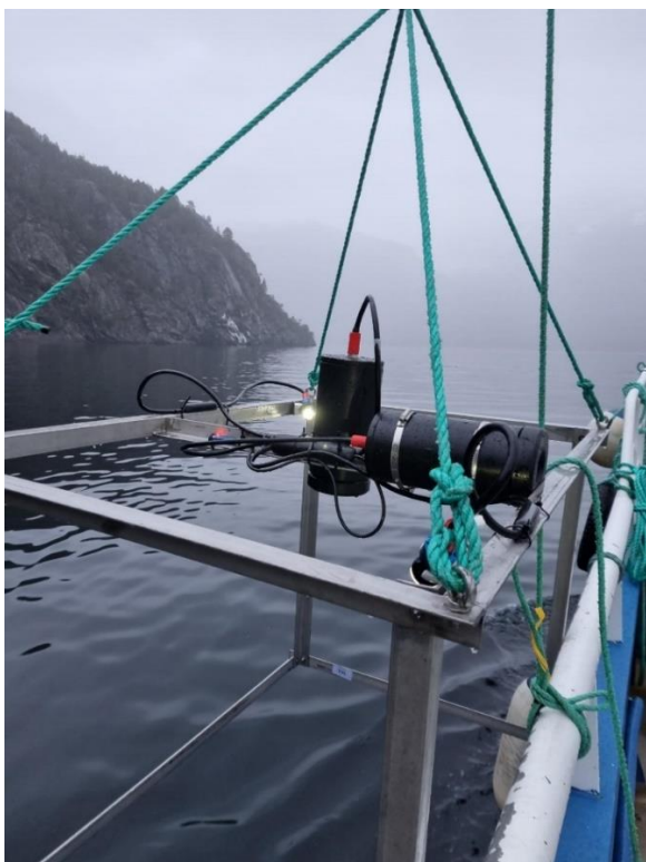
Figur 2.2.1 Hardbunnssrigg som ble benyttet i den alternative undersøkelsen.
