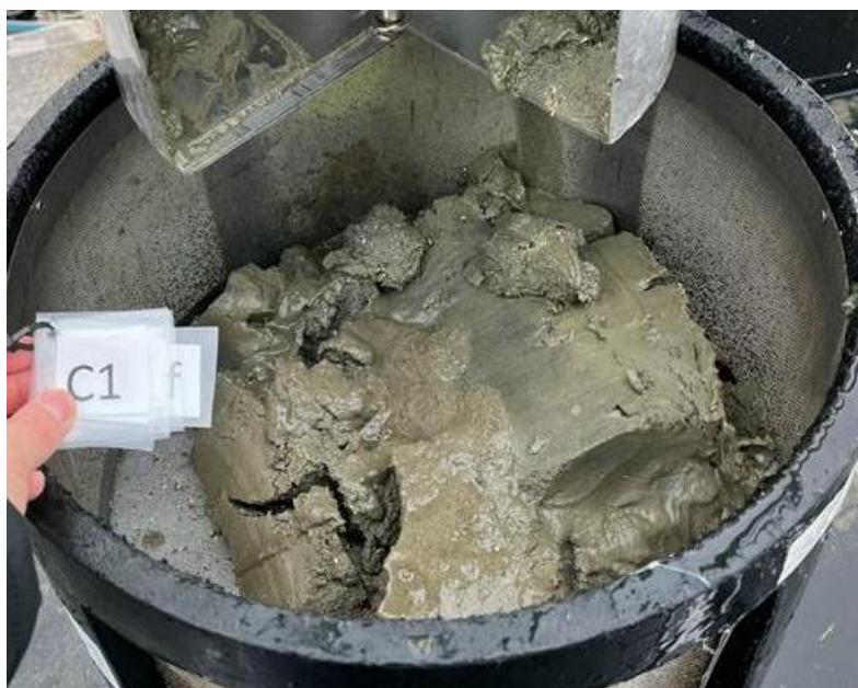
Figur 9-1: Bilde av sedimentet ved C1. Sedimentet besto av leire, sand, silt og skjellsand. Foto: Aqua Kompetanse AS.
