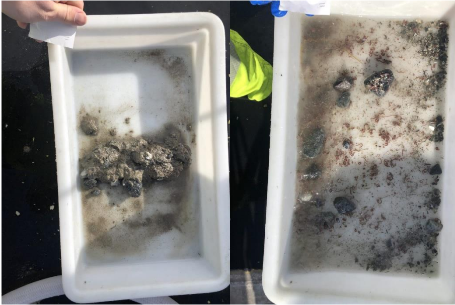
Figur 11: Bilder som viser sedimentet fra stasjon 11. Sedimentet besto av silt, sand og noe stein. Foto: Aqua Kompetanse AS.
