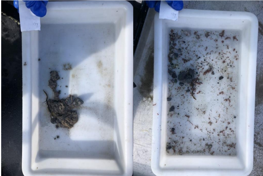
Figur 5: Bilder som viser sedimentet fra stasjon 5 før og etter siling. Sedimentet besto av silt og sand. Foto: Aqua Kompetanse AS.
