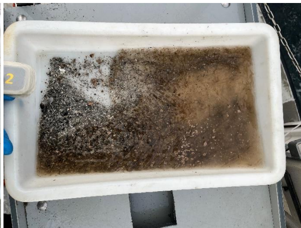
Figur 7: Bilder som viser sedimentet fra stasjon 2 før og etter siling. Sedimentet besto av skjellsand, sand og grus. Det ble registrert fôrrester og fekalier i denne prøven. Foto: Aqua Kompetanse AS.
