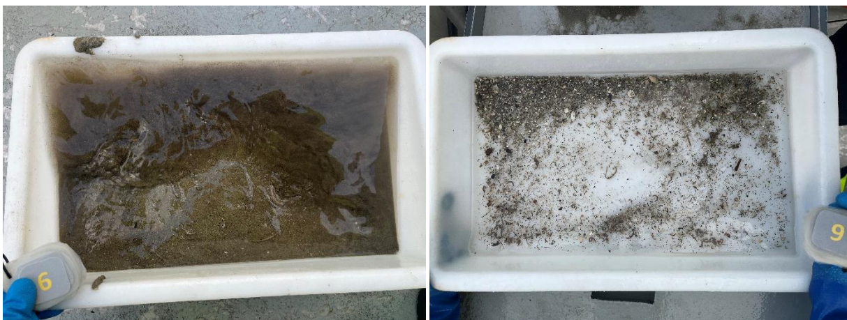
Figur 11: Bilder som viser sedimentet fra stasjon 6 før og etter siling. Sedimentet besto av sand og skjellsand. Foto: Aqua Kompetanse AS.
