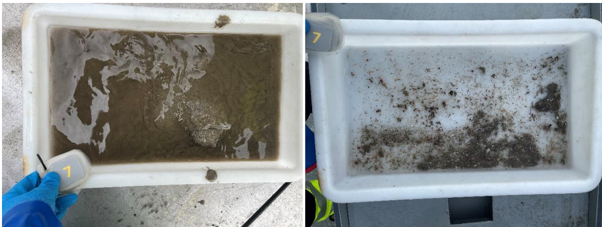
Figur 12: Bilder som viser sedimentet fra stasjon 7 før og etter siling. Sedimentet besto av skjellsand og sand. Foto: Aqua Kompetanse AS.
