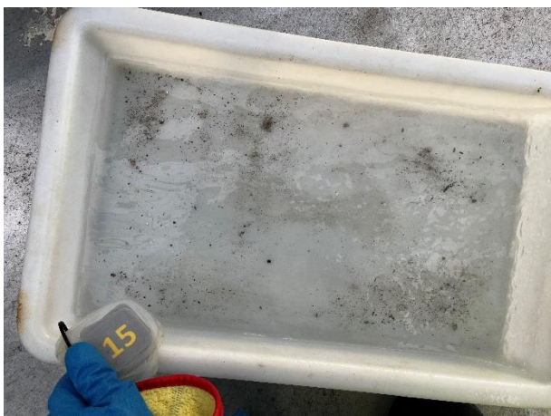
Figur 20: Bilder som viser sedimentet fra stasjon 15. Sedimentet besto av skjellsand på fjellbunn. Foto: Aqua Kompetanse AS.
