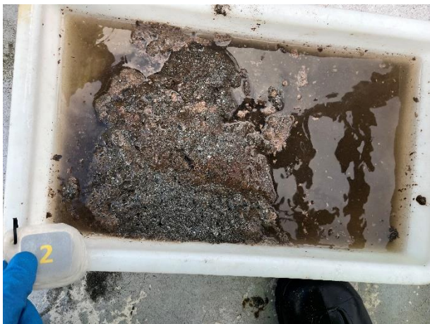
Figur 7: Bilder som viser sedimentet fra stasjon 2 før og etter siling. Sedimentet besto av skjellsand, sand og grus. Det ble registrert fôrrester og fekalier i denne prøven. Foto: Aqua Kompetanse AS.
