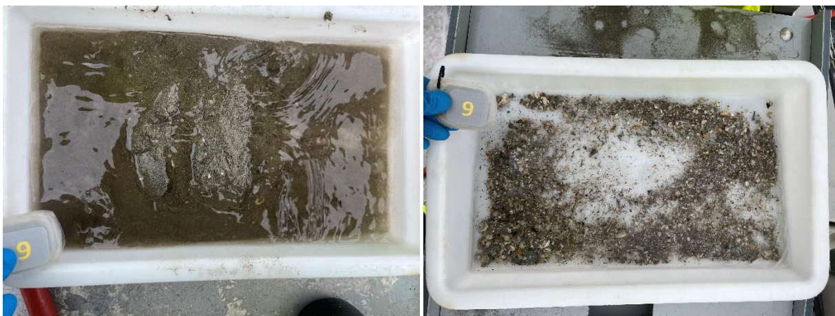
Figur 14: Bilder som viser sedimentet fra stasjon 9 før og etter siling. Sedimentet besto av skjellsand, sand og silt på fjellbunn. Foto: Aqua Kompetanse AS.
