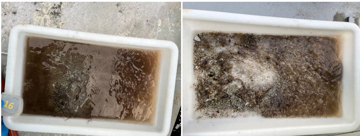
Figur 21: Bilder som viser sedimentet fra stasjon 16 før og etter siling. Sedimentet besto av skjellsand og grus. Foto: Aqua Kompetanse AS.
