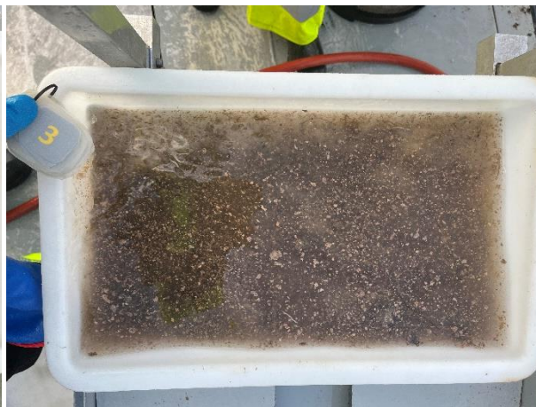
Figur 8: Bilder som viser sedimentet fra stasjon 3 før og etter siling. Sedimentet besto av skjellsand og sand. Det ble registrert fôrrester og fekalier i denne prøven. Foto: Aqua Kompetanse AS.
