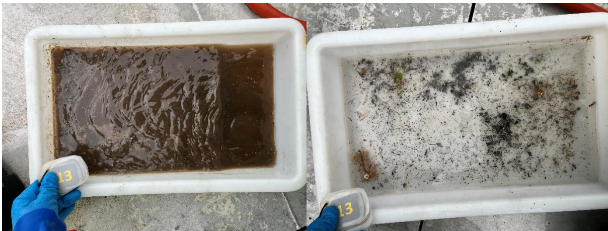
Figur 18: Bilder som viser sedimentet fra stasjon 13 før og etter siling. Sedimentet besto av sand og grus på fjellbunn. Det ble funnet fôr og fekalier i denne prøven. Foto: Aqua Kompetanse AS.
