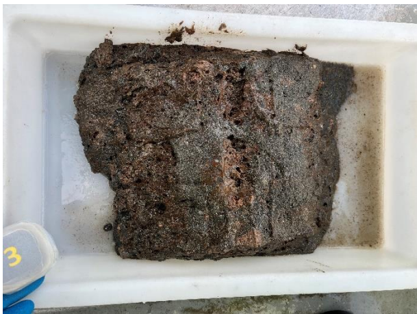
Figur 8: Bilder som viser sedimentet fra stasjon 3 før og etter siling. Sedimentet besto av skjellsand og sand. Det ble registrert fôrrester og fekalier i denne prøven. Foto: Aqua Kompetanse AS.
