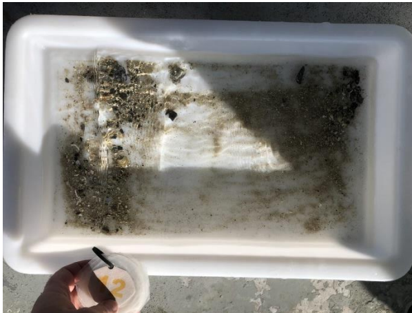
Figur 12: Bilde som viser grabbinnhold fra stasjon 12. Sedimentet besto av strø av skjellsand på steinbunn. Foto: Aqua Kompetanse AS.
