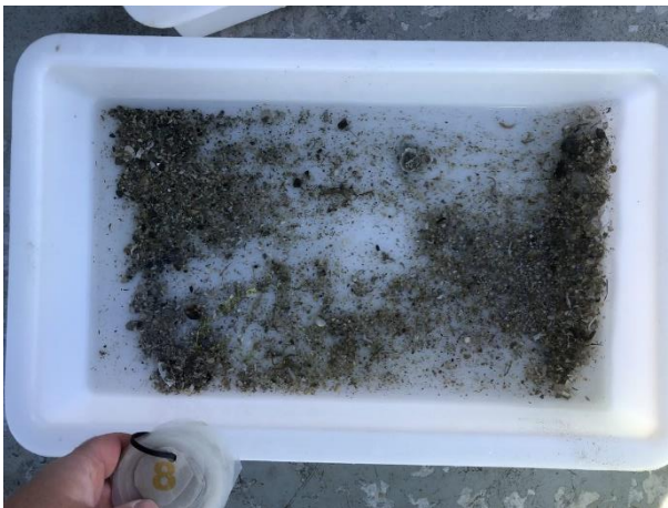
Figur 8: Bilde som viser sedimentet fra stasjon 8 etter siling. Sedimentet besto av sand og skjellsand. Det ble ikke tatt bilde før siling på grunn av tekniske problemer. Foto: Aqua Kompetanse AS.
