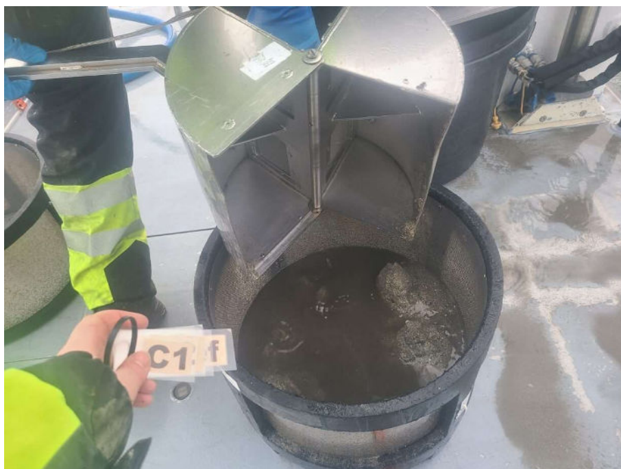
Figur 9-1: Bilde av sedimentet ved C1. Sedimentet besto av sand og skjellsand. Det ble registrert fekalier ved stasjonen. Foto: Aqua Kompetanse AS.
