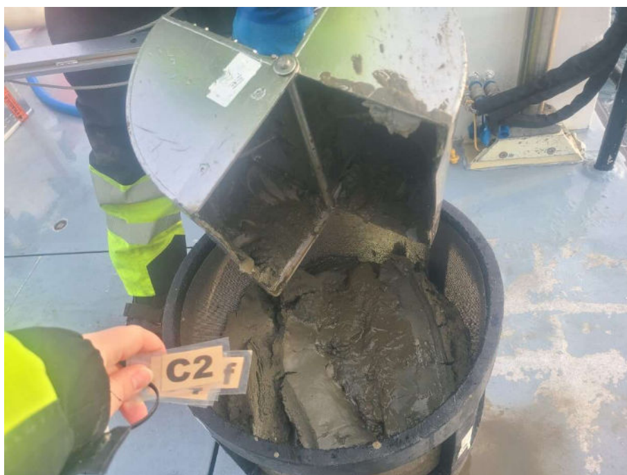
Figur 9-2: Bilde av sedimentet ved C2. Sedimentet besto av leire og silt. Foto: Aqua Kompetanse AS.
