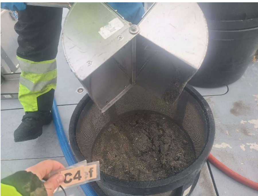
Figur 9-4: Bilde av sedimentet ved C4. Sedimentet besto av sand og skjellsand. Foto: Aqua Kompetanse AS.
