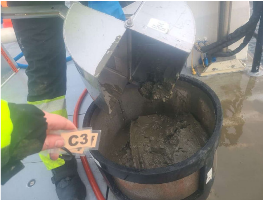
Figur 9-3: Bilde av sedimentet ved C3. Sedimentet besto av leire og silt. Foto: Aqua Kompetanse AS.
