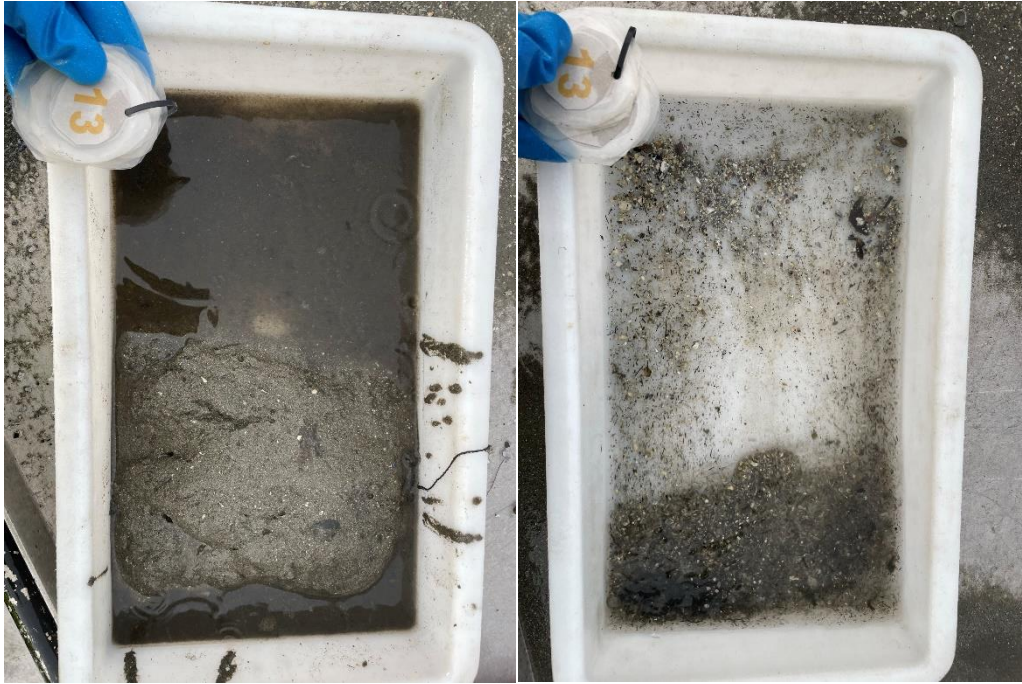
Figur 13: Bilder som viser sedimentet fra stasjon 13 før og etter siling. Sedimentet besto av silt og sand. Foto: Aqua Kompetanse AS.
