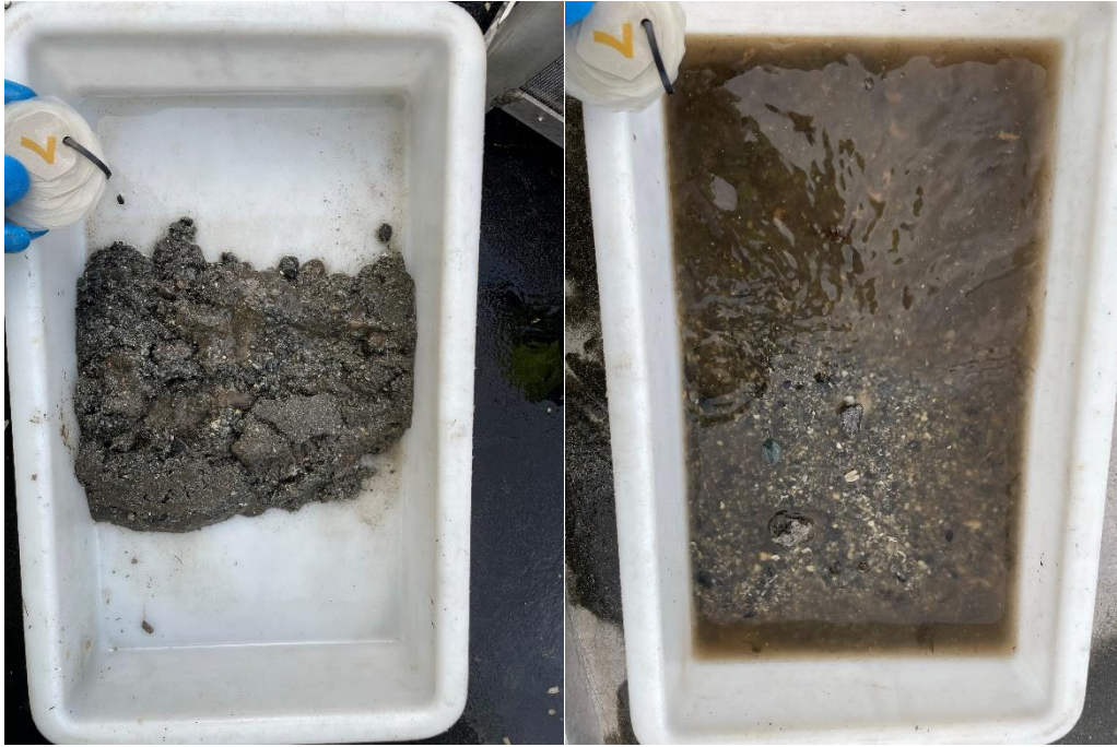
Figur 7: Bilder som viser sedimentet fra stasjon 7 før og etter siling. Sedimentet besto av silt, sand og grus. Det ble registrert rester av fekalier ved stasjonen. Foto: Aqua Kompetanse AS.
