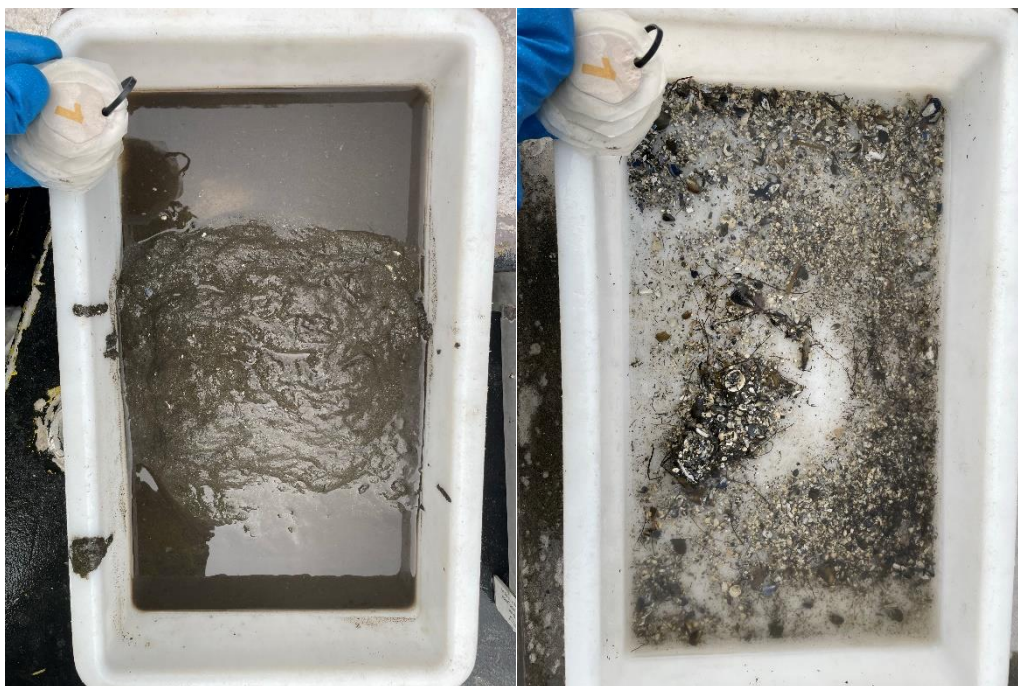
Figur 1: Bilder som viser sedimentet fra stasjon 1 før og etter siling. Sedimentet besto av silt og sand. Det ble registrert rester av fekalier ved stasjonen. Foto: Aqua Kompetanse AS.
