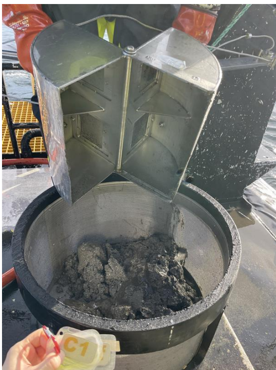
Figur 9-1: Bilde av sedimentet ved C1. Sedimentet besto av sand, silt og skjellsand. Foto: Aqua Kompetanse AS.
