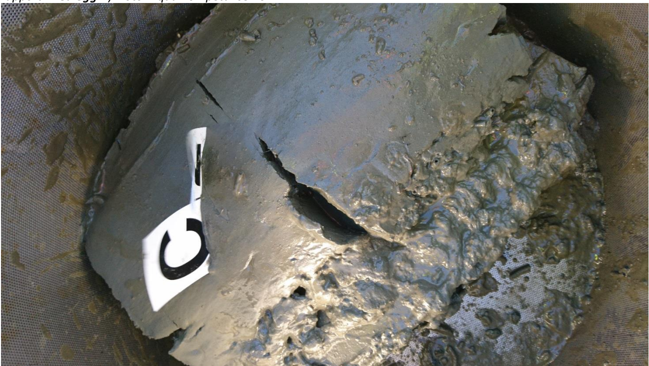
Figur 7: Bilde av sedimentet ved C2. Sedimentet besto av leire, og hadde en pelittandel på 88% (se Akvaplan-niva rapport i Vedlegg A ). Foto: Aqua Kompetanse AS.
