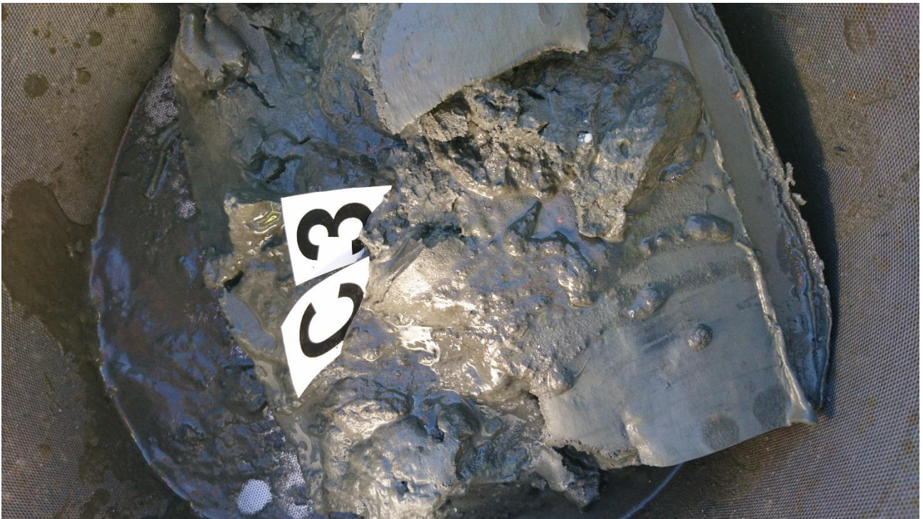
Figur 8: Bilde av sedimentet ved C3. Sedimentet besto av leire og silt, og hadde en pelittandel på 76% (se Akvaplan-niva rapport i Vedlegg A ). Foto: Aqua Kompetanse AS.
