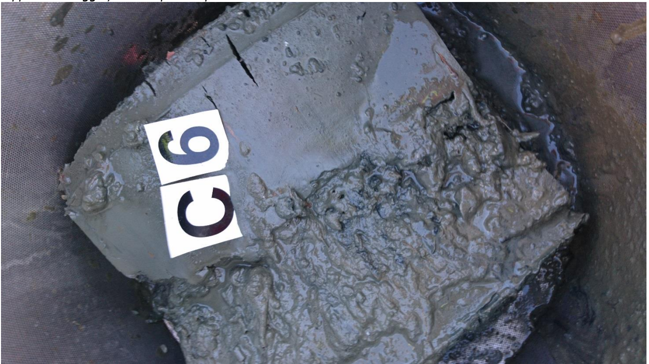
Figur 11: Bilde av sedimentet ved C6. Sedimentet besto av leire og silt, og hadde en pelittandel på 95% (se Akvaplan-niva rapport i Vedlegg A). Foto: Aqua Kompetanse AS.
