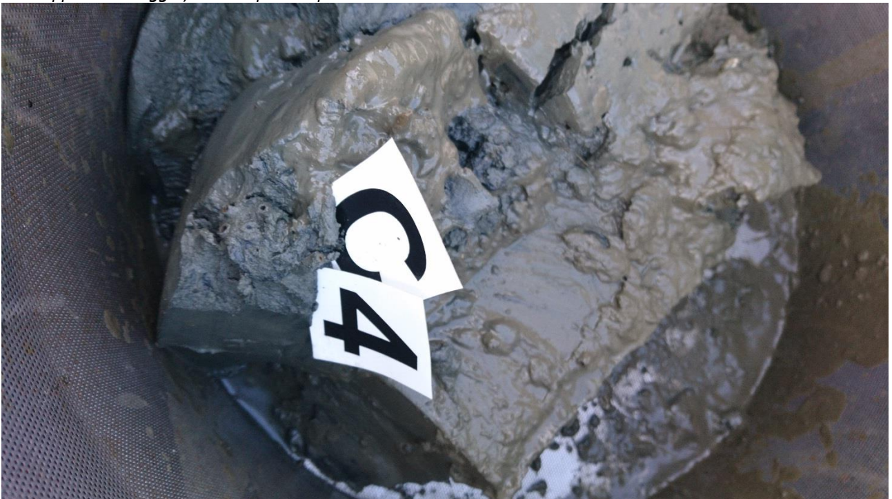
Figur 9: Bilde av sedimentet ved C4. Sedimentet besto av leire og silt, og hadde en pelittandel på 94% (se Akvaplan-niva rapport i Vedlegg A ). Foto: Aqua Kompetanse AS.
