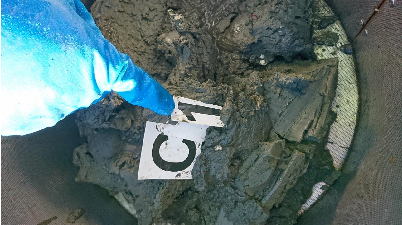
Figur 6: Bilde av sedimentet ved C1. Sedimentet besto av leire, og hadde en pelittandel på 75% (se Akvaplan-niva rapport i Vedlegg A ). Foto: Aqua Kompetanse AS.
