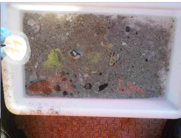
Figur 16: Bilder som viser sedimentet fra stasjon 11 før og etter siling. Sedimentet besto av sand og skjellsand. Foto: Aqua Kompetanse AS.
