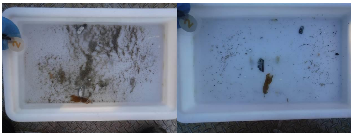
Figur 7: Bilder som viser sedimentet fra stasjon 2 før og etter siling. Sedimentet besto av sand på fjellbunn. Det ble registrert fekalier i denne prøven. Foto: Aqua Kompetanse AS.
