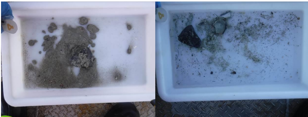
Figur 9: Bilder som viser sedimentet fra stasjon 4 før og etter siling. Sedimentet besto av sand og skjellsand. Det ble registrert fekalier i denne prøven. Foto: Aqua Kompetanse AS.
