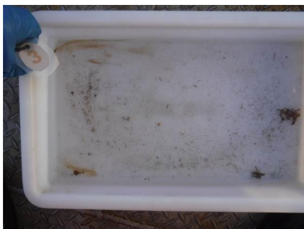
Figur 8: Bilde som viser sedimentet fra stasjon 3. Sedimentet besto av strøsand på fjellbunn. Det ble registrert fekalier i denne prøven. Foto: Aqua Kompetanse AS.
