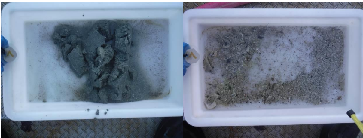
Figur 12: Bilder som viser sedimentet fra stasjon 7 før og etter siling. Sedimentet besto av sand og skjellsand. Foto: Aqua Kompetanse AS.
