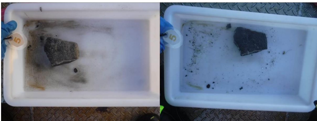
Figur 10: Bilder som viser sedimentet fra stasjon 5 før og etter siling. Sedimentet besto av noe grus på stein og fjellbunn. Foto: Aqua Kompetanse AS.
