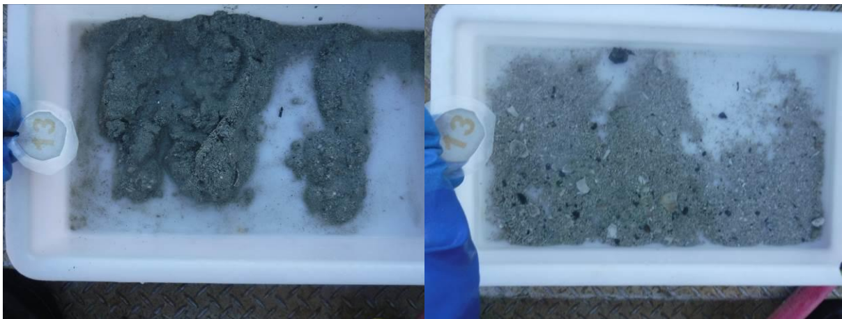
Figur 18: Bilder som viser sedimentet fra stasjon 13 før og etter siling. Sedimentet besto av sand og skjellsand. Foto: Aqua Kompetanse AS.
