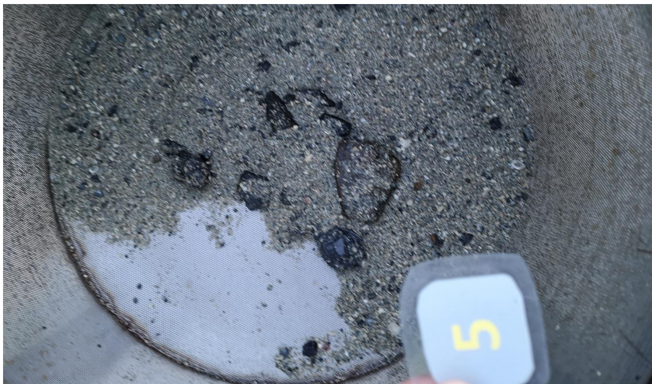
Figur A-5: Bilde av sedimentet ved C5. Sedimentet besto av skjellsand og grov sand, og hadde en pelittandel på 6,0% (se Eurofins AS rapport i Vedlegg B ). Foto: Aqua Kompetanse AS.
