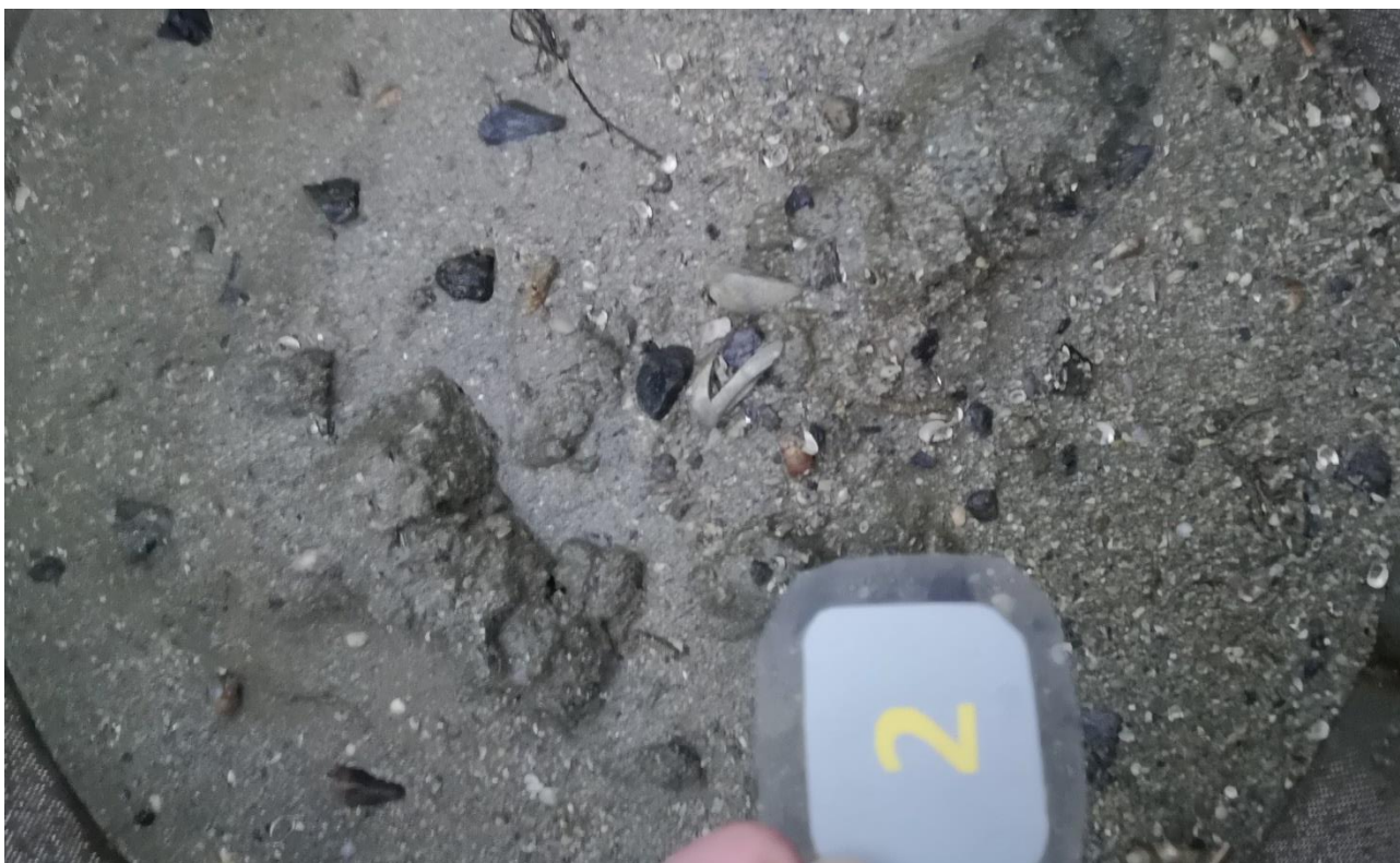
Figur A-2: Bilde av sedimentet ved C2. Sedimentet besto av skjellsand, sand og stein, og hadde en pelittandel på 25,0% (se Eurofins AS rapport i Vedlegg B ). Foto: Aqua Kompetanse AS.
