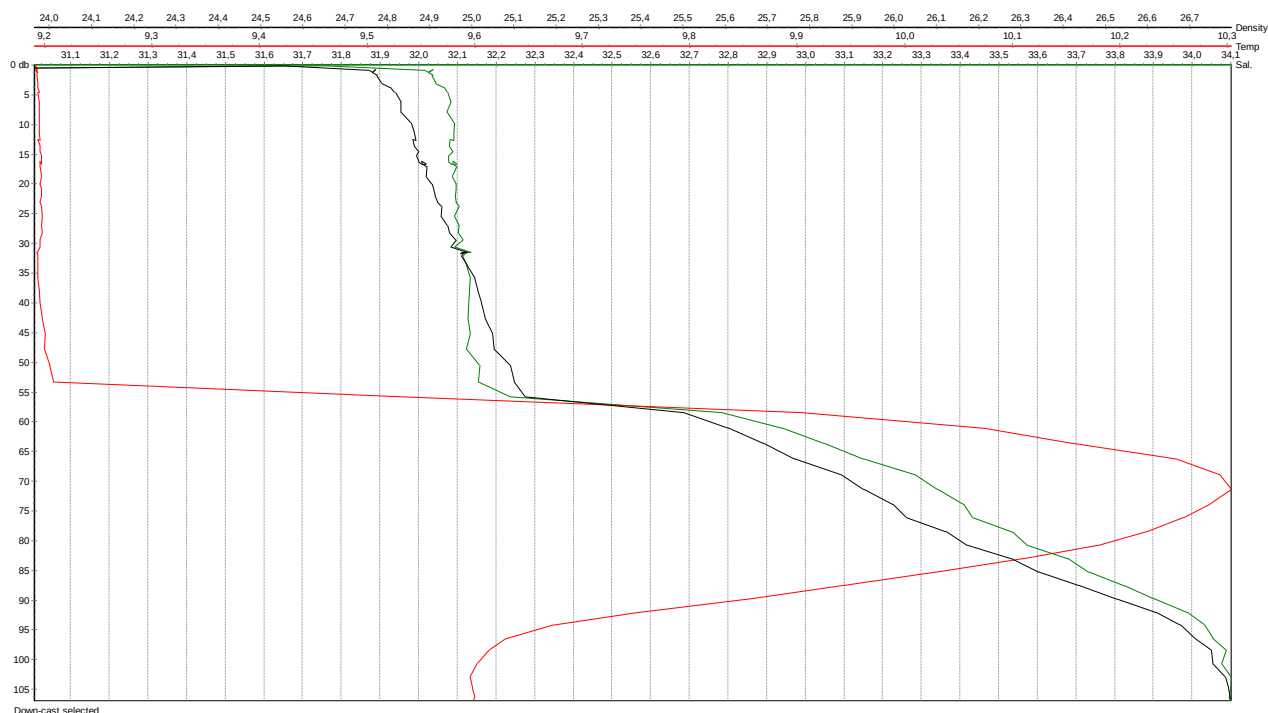
Figur 4: Sjøtemperatur (°C; rød), salinitet (grønn) og tetthet (-1000 kg/m 3 ) fra overflaten og ned til bunnen (down-cast) på 107 meters dyp ved stasjon C1 den 16.11.2018.
