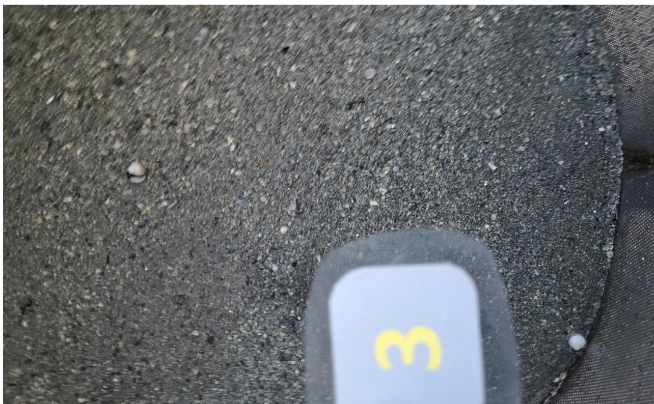
Figur A-3: Bilde av sedimentet ved C3. Sedimentet besto av sand, skjellsand og stein, og hadde en pelittandel på 8,6% (se Eurofins AS rapport i Vedlegg B ). Foto: Aqua Kompetanse AS.
