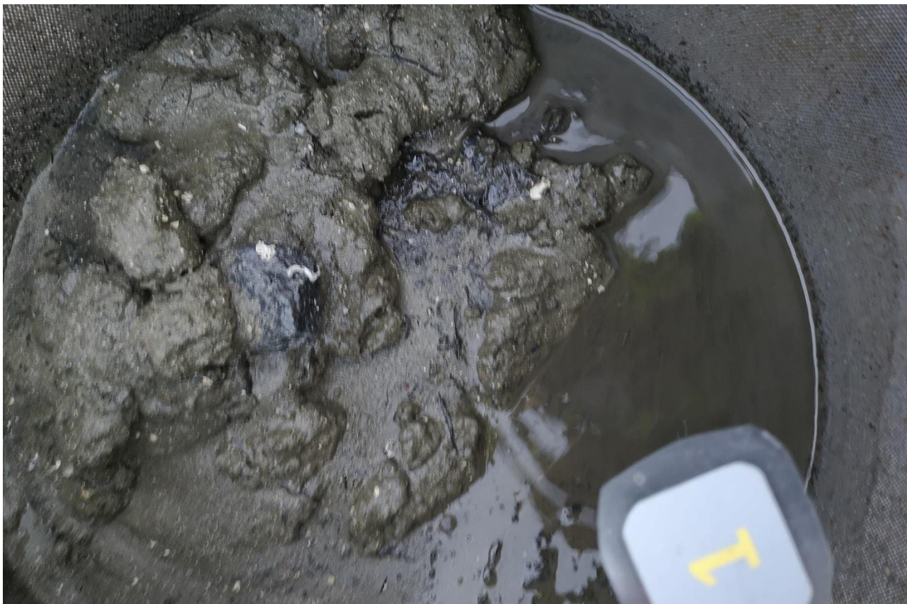
Figur A-1: Bilde av sedimentet ved C1. Sedimentet besto av sand og skjellsand, og hadde en pelittandel på 29,5% (se Eurofins AS rapport i Vedlegg B ). Foto: Aqua Kompetanse AS.
