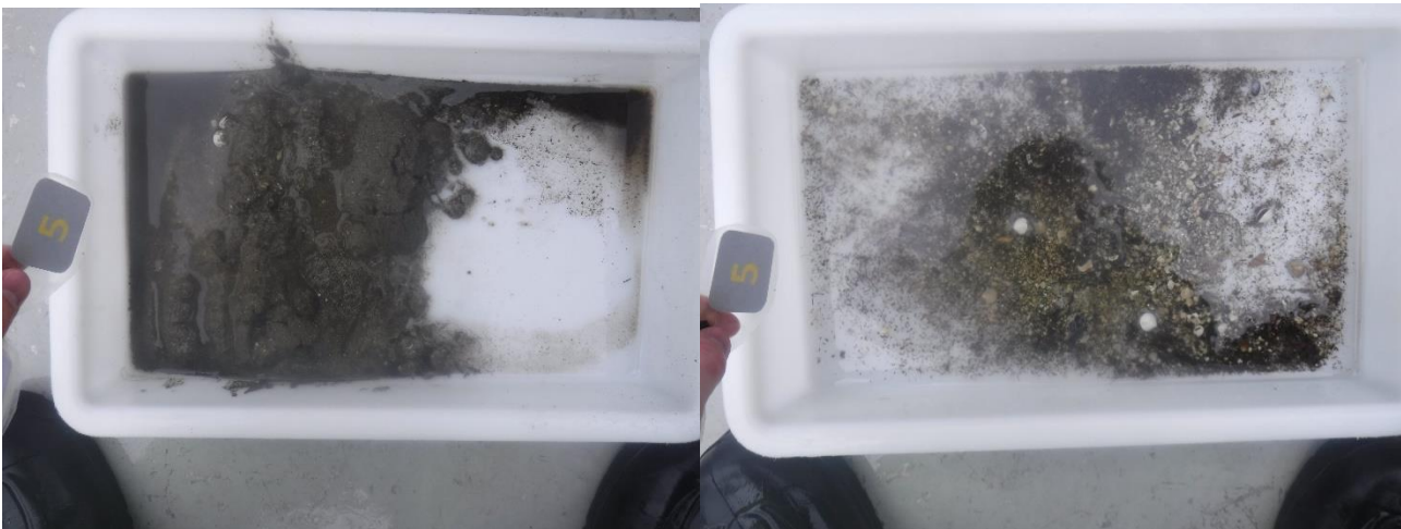
Figur 10: Bilder som viser sedimentet fra stasjon 5 før og etter siling. Sedimentet besto av silt, sand og skjellsand. Foto: Aqua Kompetanse AS.
