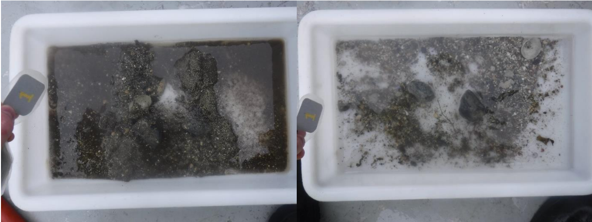
Figur 6: Bilder som viser sedimentet fra stasjon 1 før og etter siling. Sedimentet besto av sand, grus og skjellsand. Foto: Aqua Kompetanse AS.
