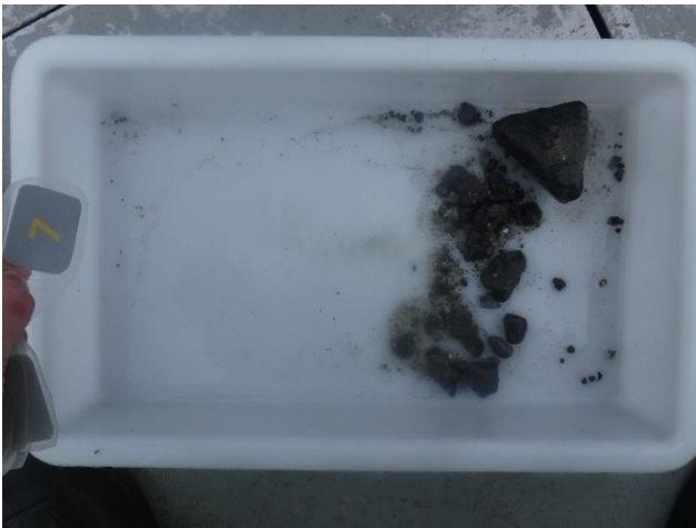
Figur 12: Bilde som viser sedimentet fra stasjon 7. Sedimentet besto av strø av grus på stein- og fjellbunn. Foto: Aqua Kompetanse AS.
