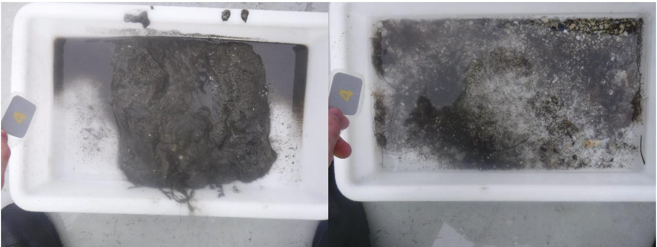
Figur 9: Bilder som viser sedimentet fra stasjon 4 før og etter siling. Sedimentet besto av silt og sand. Foto: Aqua Kompetanse AS.
