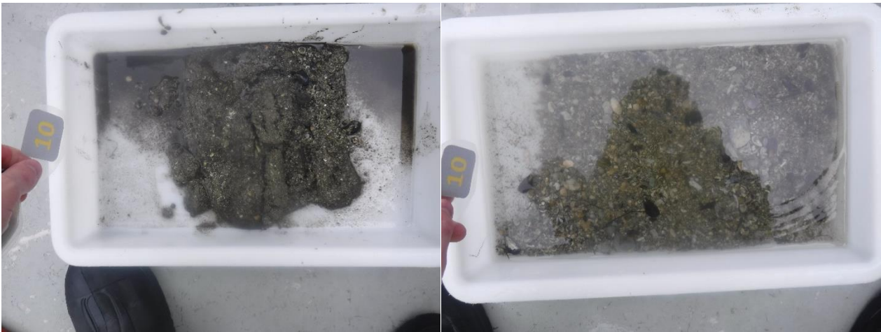
Figur 15: Bilder som viser sedimentet fra stasjon 10 før og etter siling. Sedimentet besto av sand, grus og skjellsand. Foto: Aqua Kompetanse AS.
