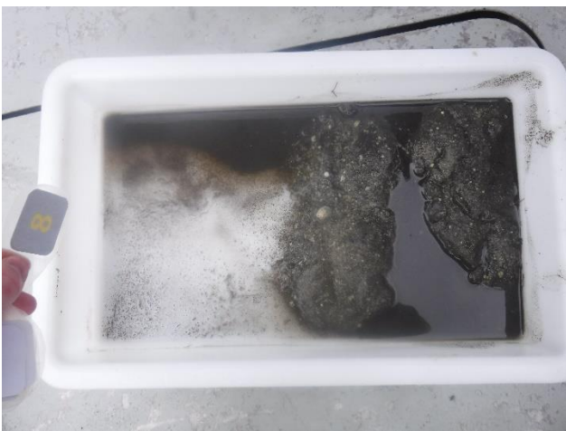
Figur 13: Bilder som viser sedimentet fra stasjon 8 før og etter siling. Sedimentet besto av silt, sand og skjellsand. Foto: Aqua Kompetanse AS.
