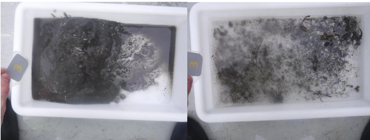
Figur 8: Bilder som viser sedimentet fra stasjon 3 før og etter siling. Sedimentet besto av silt, sand og skjellsand. Det ble funnet fekalier i denne prøven. Foto: Aqua Kompetanse AS.
