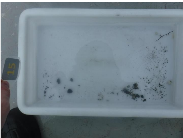
Figur 20: Bilde som viser sedimentet fra stasjon 15. Sedimentet besto av strø av grus på fjellbunn. Foto: Aqua Kompetanse AS.
