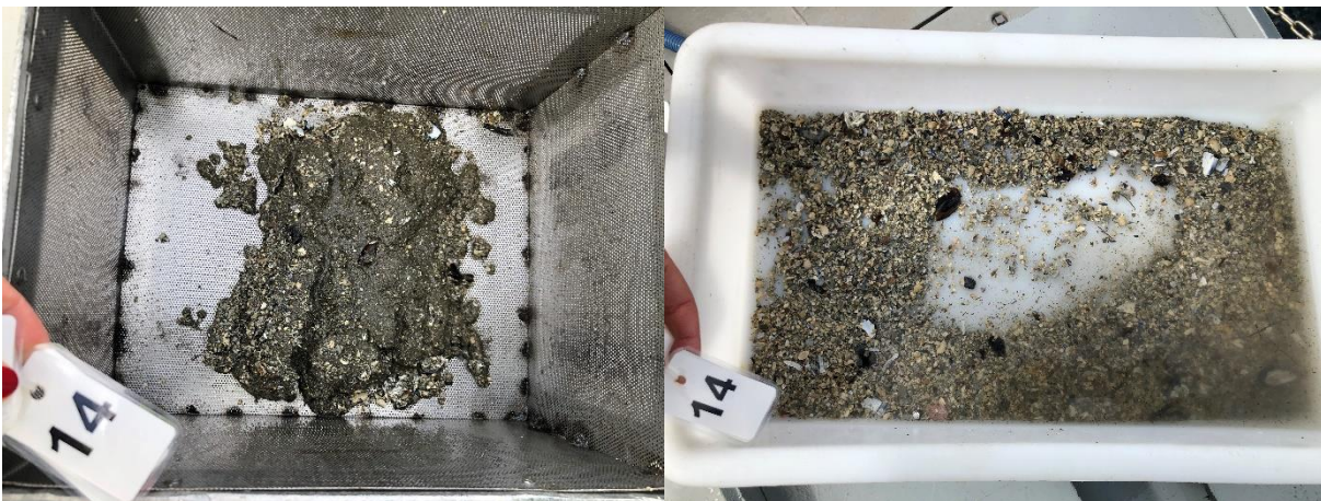
Figur 19: Bilder som viser sedimentet fra stasjon 14 før og etter siling. Sedimentet besto av sand og skjellsand. Foto: Aqua Kompetanse AS.
