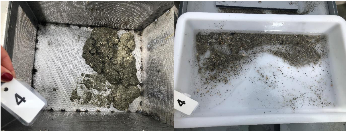
Figur 9: Bilder som viser sedimentet fra stasjon 4 før og etter siling. Sedimentet besto av sand og skjellsand. Foto: Aqua Kompetanse AS.
