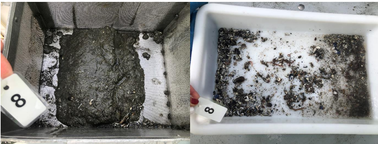
Figur 13: Bilder som viser sedimentet fra stasjon 8 før og etter siling. Sedimentet besto av sand og skjellsand. Foto: Aqua Kompetanse AS.
