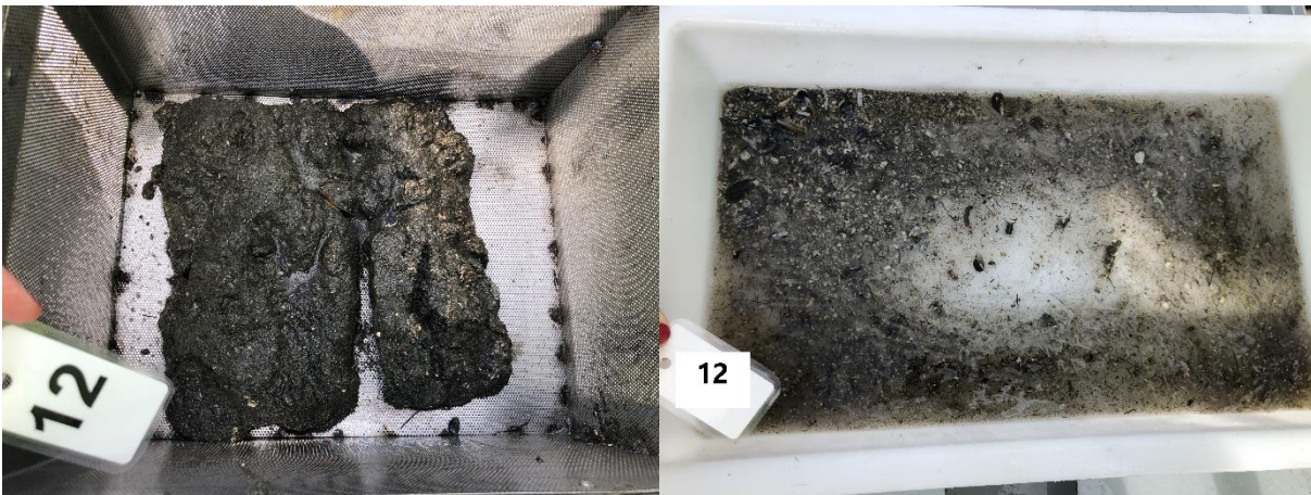
Figur 17: Bilder som viser sedimentet fra stasjon 12 før og etter siling. Sedimentet besto av sand, silt og skjellsand. Det ble registrert fôrrester i denne prøven. Foto: Aqua Kompetanse AS.
