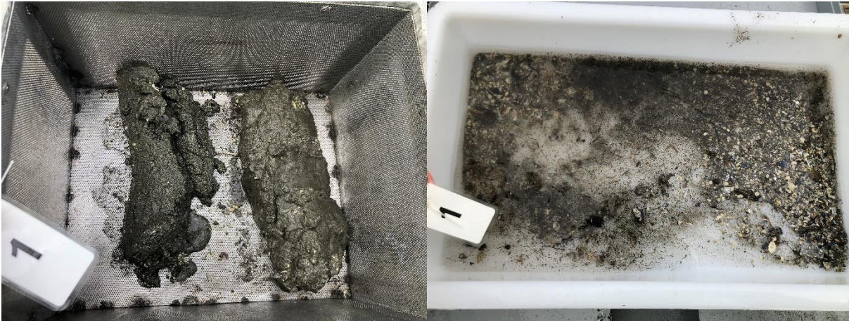
Figur 6: Bilder som viser sedimentet fra stasjon 1 før og etter siling. Sedimentet besto av sand, silt og skjellsand. Foto: Aqua Kompetanse AS.
