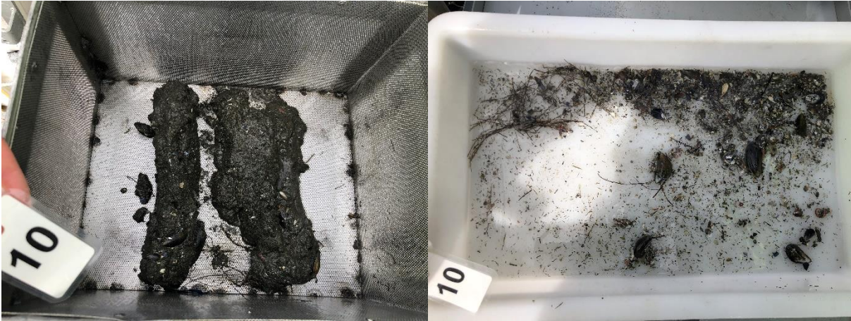
Figur 15: Bilder som viser sedimentet fra stasjon 10 før og etter siling. Sedimentet besto av sand og skjellsand. Foto: Aqua Kompetanse AS.
