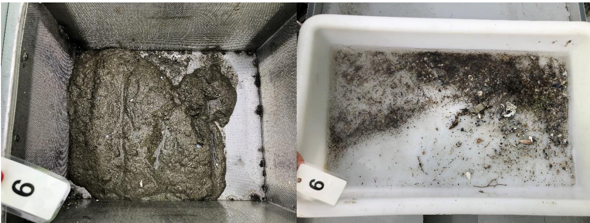
Figur 11: Bilder som viser sedimentet fra stasjon 6 før og etter siling. Sedimentet besto av sand og silt. Foto: Aqua Kompetanse AS.
