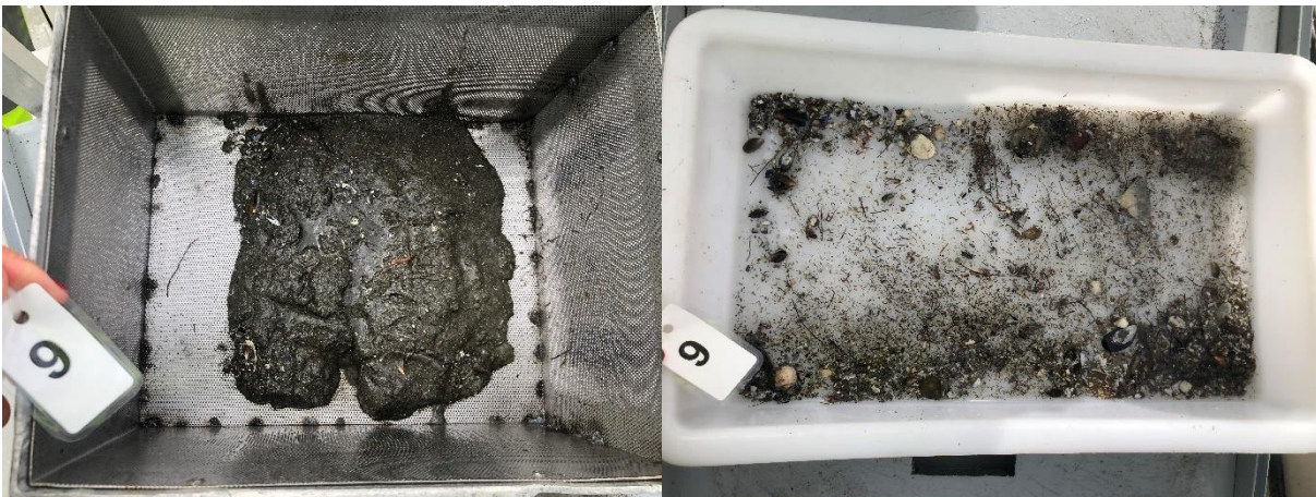
Figur 14: Bilder som viser sedimentet fra stasjon 9 før og etter siling. Sedimentet besto av sand og skjellsand. Foto: Aqua Kompetanse AS.
