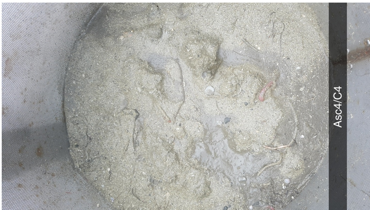
Figur 9: Bilde av sedimentet ved C4. Sedimentet besto av skjellsand, og hadde en pelittandel på 14,7% (se Akvaplan-niva rapport i Vedlegg A ). Foto: Aqua Kompetanse AS.
