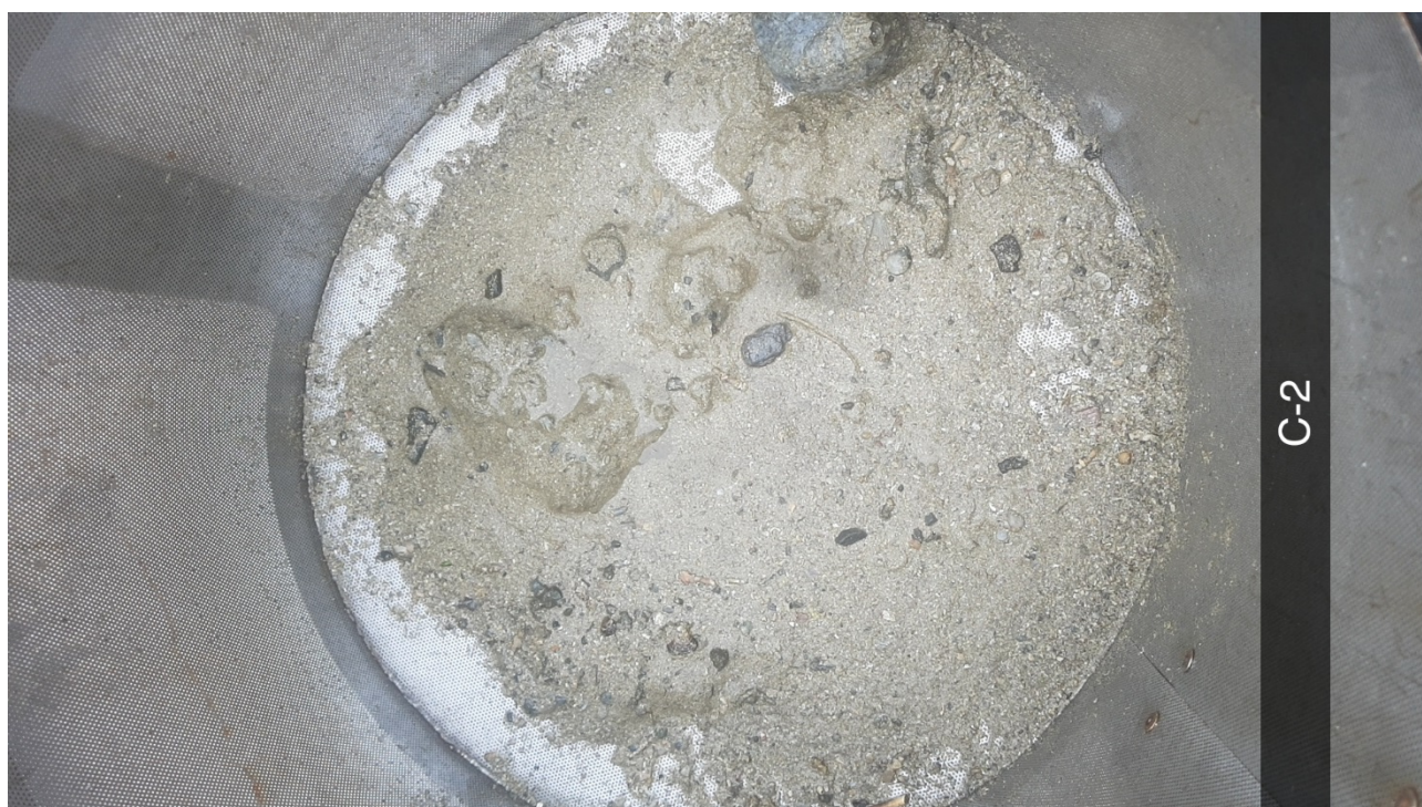
Figur 7: Bilde av sedimentet ved C2. Sedimentet besto av skjellsand, og hadde en pelittandel på 9,4% (se Akvaplan-niva rapport i Vedlegg A ). Foto: Aqua Kompetanse AS.
