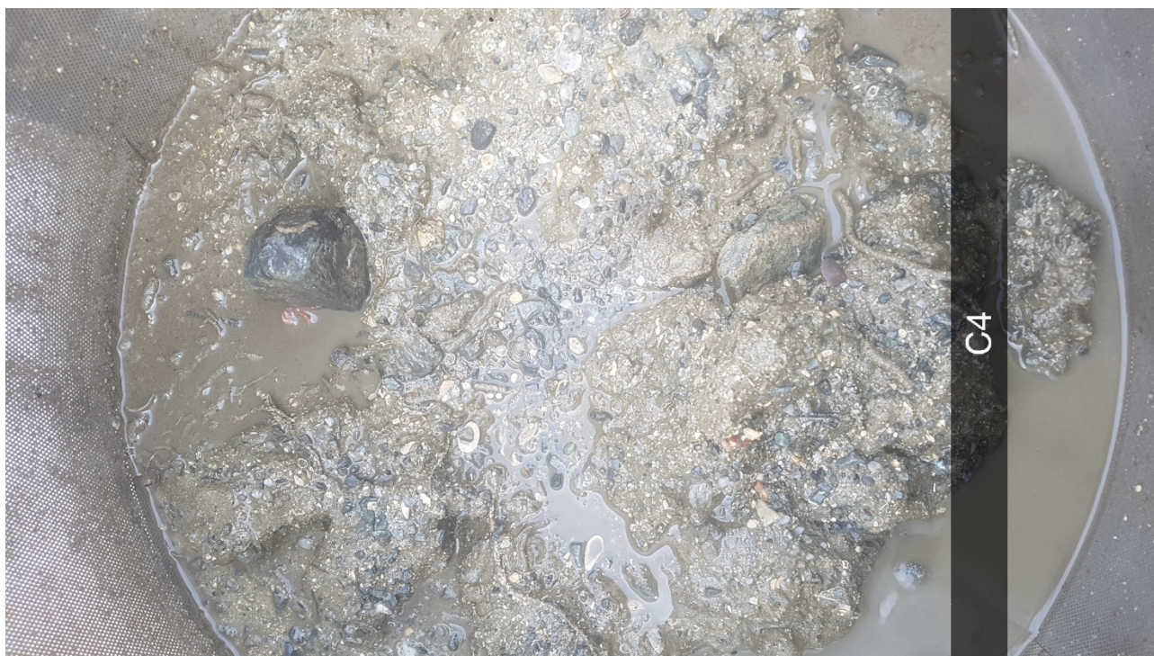
Figur 10: Bilde av sedimentet ved C5. Sedimentet besto av grus, skjellsand og sand, og hadde en pelittandel på 23,1% (se Akvaplan-niva rapport i Vedlegg A ). Foto: Aqua Kompetanse AS. NB, bildet er merket feil.
