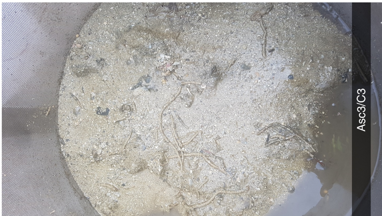
Figur 8: Bilde av sedimentet ved C3. Sedimentet besto av skjellsand, og hadde en pelittandel på 10,8% (se Akvaplan-niva rapport i Vedlegg A ). Foto: Aqua Kompetanse AS.
