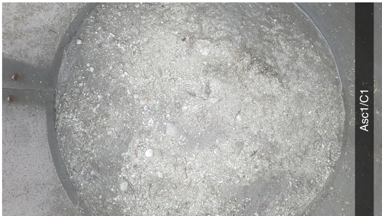
Figur 6: Bilde av sedimentet ved C1. Sedimentet besto av skjellsand og sand, og hadde en pelittandel på 9,8% (se Akvaplan-niva rapport i Vedlegg A ). Foto: Aqua Kompetanse AS.
