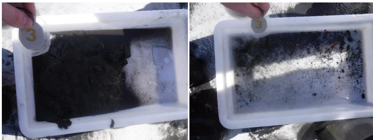
Figur 8: Bilder som viser sedimentet fra stasjon 3 før og etter siling. Sedimentet besto av silt, sand og skjellsand. Foto: Aqua Kompetanse AS.
