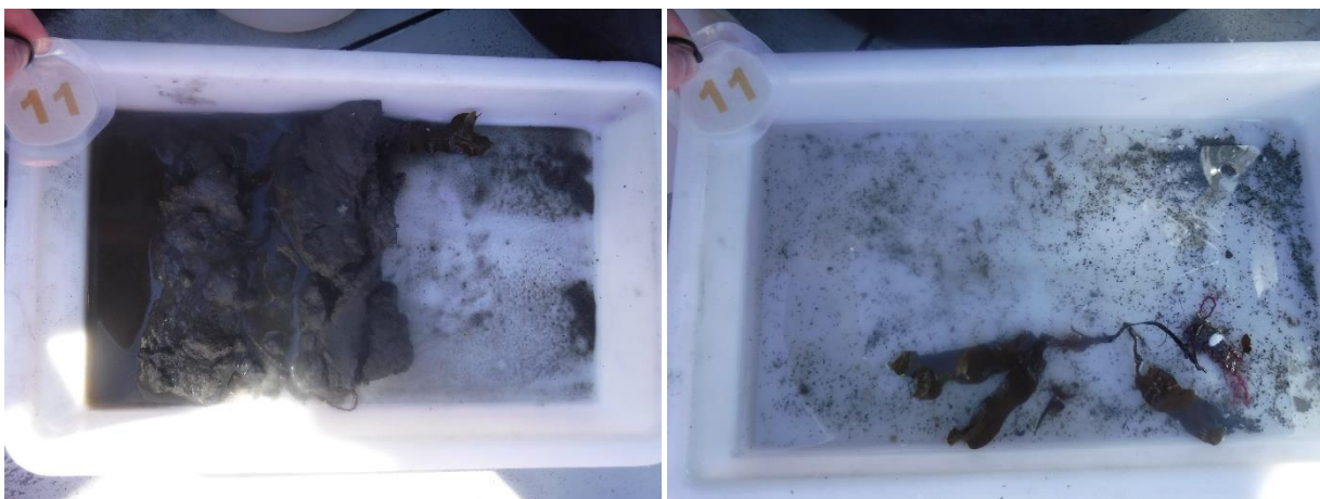
Figur 16: Bilder som viser sedimentet fra stasjon 11 før og etter siling. Sedimentet besto av silt, sand og skjellsand. Foto: Aqua Kompetanse AS.
