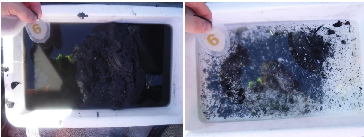
Figur 11: Bilder som viser sedimentet fra stasjon 6 før og etter siling. Sedimentet besto av silt, sand, grus og skjellsand. Foto: Aqua Kompetanse AS.
