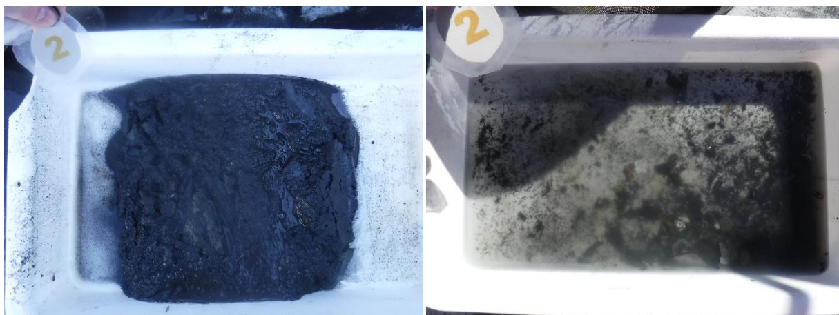
Figur 7: Bilder som viser sedimentet fra stasjon 2 før og etter siling. Sedimentet besto av silt og skjellsand. Foto: Aqua Kompetanse AS.
