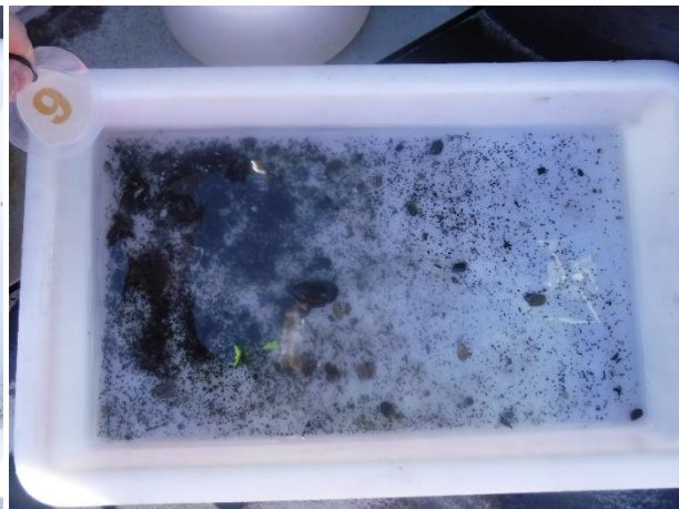
Figur 14: Bilder som viser sedimentet fra stasjon 9 før og etter siling. Sedimentet besto av silt, sand, grus og skjellsand. Foto: Aqua Kompetanse AS.
