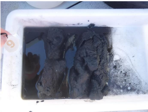
Figur 14: Bilder som viser sedimentet fra stasjon 9 før og etter siling. Sedimentet besto av silt, sand, grus og skjellsand. Foto: Aqua Kompetanse AS.
