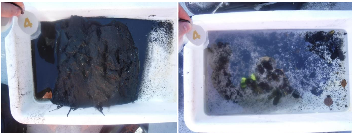
Figur 9: Bilder som viser sedimentet fra stasjon 4 før og etter siling. Sedimentet besto av silt, sand og skjellsand. Foto: Aqua Kompetanse AS.
