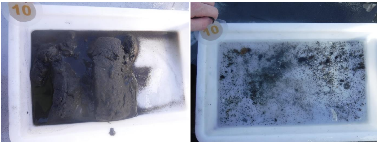
Figur 15: Bilder som viser sedimentet fra stasjon 10 før og etter siling. Sedimentet besto av silt, sand, grus og skjellsand. Foto: Aqua Kompetanse AS.
