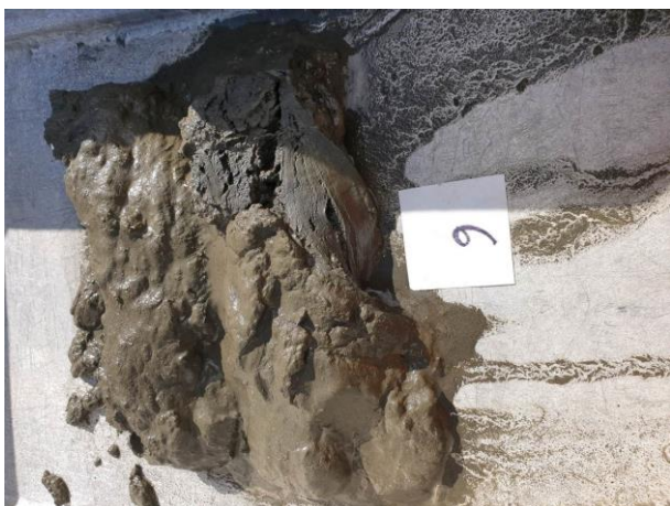
Figur 14: Bilder som viser sedimentet fra stasjon 9 før og etter siling. Sedimentet besto av leire, silt og sand. Foto: Aqua Kompetanse AS.
