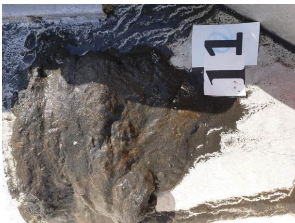
Figur 16: Bilder som viser sedimentet fra stasjon 11 før og etter siling. Sedimentet besto av leire, silt og sand. Det ble registrert fekalier i denne prøven. Foto: Aqua Kompetanse AS.
