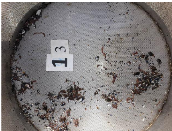
Figur 18: Bilder som viser sedimentet fra stasjon 13 før og etter siling. Sedimentet besto av leire, silt og sand. Foto: Aqua Kompetanse AS.
