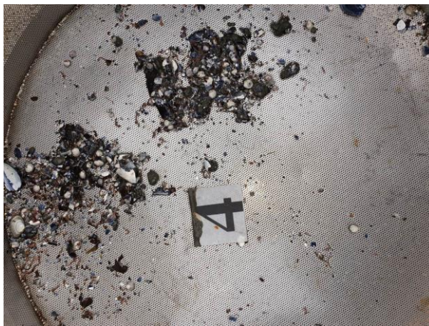
Figur 9: Bilder som viser sedimentet fra stasjon 4 før og etter siling. Sedimentet besto av leire, silt og sand. Foto: Aqua Kompetanse AS.
