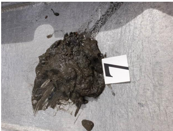
Figur 12: Bilder som viser sedimentet fra stasjon 7 før og etter siling. Sedimentet besto av leire og silt. Foto: Aqua Kompetanse AS.
