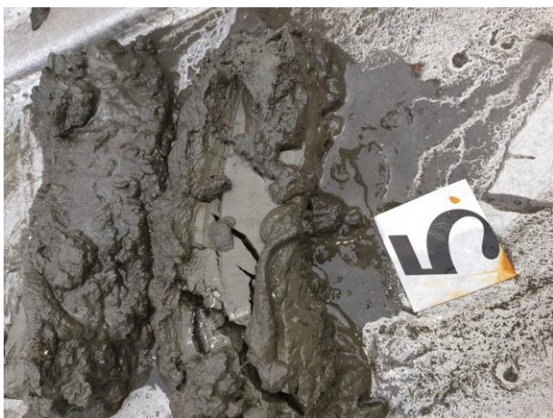
Figur 10: Bilder som viser sedimentet fra stasjon 5 før og etter siling. Sedimentet besto av leire, silt og sand. Foto: Aqua Kompetanse AS.
