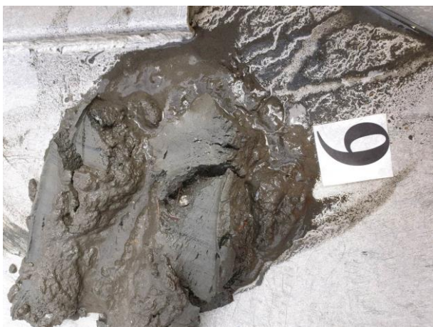
Figur 11: Bilder som viser sedimentet fra stasjon 6 før og etter siling. Sedimentet besto av leire, silt og sand. Foto: Aqua Kompetanse AS.
