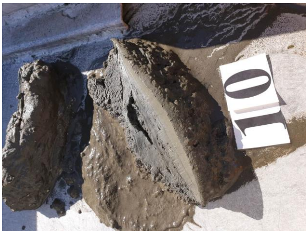
Figur 15: Bilder som viser sedimentet fra stasjon 10 før og etter siling. Sedimentet besto av leire, silt og sand. Foto: Aqua Kompetanse AS.
