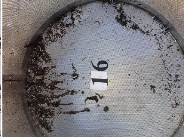
Figur 21: Bilder som viser sedimentet fra stasjon 16 før og etter siling. Sedimentet besto av leire, silt og sand. Foto: Aqua Kompetanse AS.
