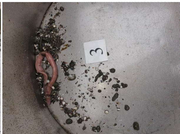
Figur 8: Bilder som viser sedimentet fra stasjon 3 før og etter siling. Sedimentet besto av leire, silt og sand. Foto: Aqua Kompetanse AS.
