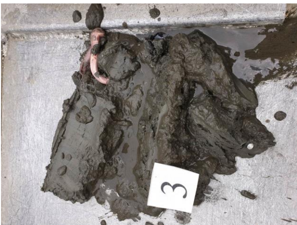
Figur 8: Bilder som viser sedimentet fra stasjon 3 før og etter siling. Sedimentet besto av leire, silt og sand. Foto: Aqua Kompetanse AS.
