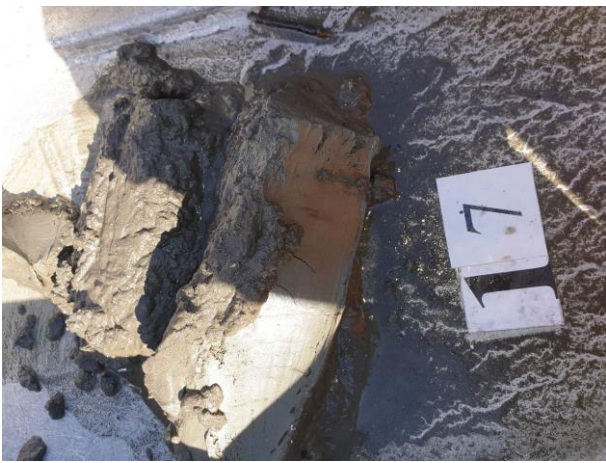
Figur 22: Bilder som viser sedimentet fra stasjon 17 før og etter siling. Sedimentet besto av leire, silt og sand. Foto: Aqua Kompetanse AS.
