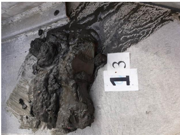
Figur 18: Bilder som viser sedimentet fra stasjon 13 før og etter siling. Sedimentet besto av leire, silt og sand. Foto: Aqua Kompetanse AS.
