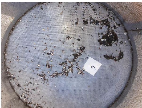
Figur 14: Bilder som viser sedimentet fra stasjon 9 før og etter siling. Sedimentet besto av leire, silt og sand. Foto: Aqua Kompetanse AS.
