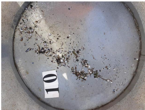
Figur 15: Bilder som viser sedimentet fra stasjon 10 før og etter siling. Sedimentet besto av leire, silt og sand. Foto: Aqua Kompetanse AS.
