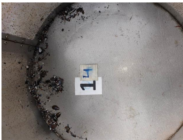
Figur 19: Bilder som viser sedimentet fra stasjon 14 før og etter siling. Sedimentet besto av leire, silt og sand. Foto: Aqua Kompetanse AS.
