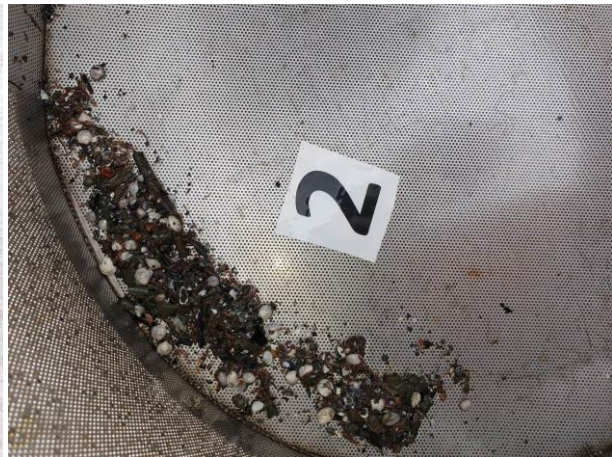
Figur 7: Bilder som viser sedimentet fra stasjon 2 før og etter siling. Sedimentet besto av leire, silt og sand. Foto: Aqua Kompetanse AS.
