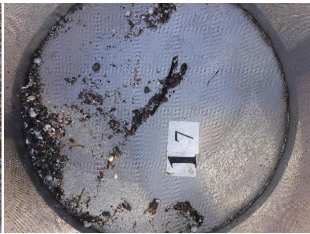
Figur 22: Bilder som viser sedimentet fra stasjon 17 før og etter siling. Sedimentet besto av leire, silt og sand. Foto: Aqua Kompetanse AS.
