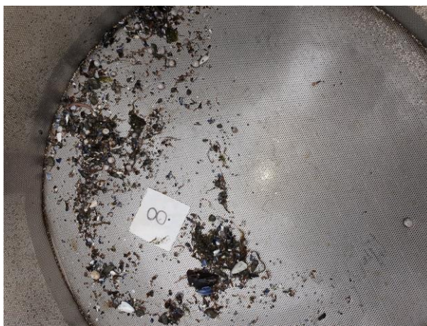
Figur 13: Bilder som viser sedimentet fra stasjon 8 før og etter siling. Sedimentet besto av leire, silt og sand. Foto: Aqua Kompetanse AS.
