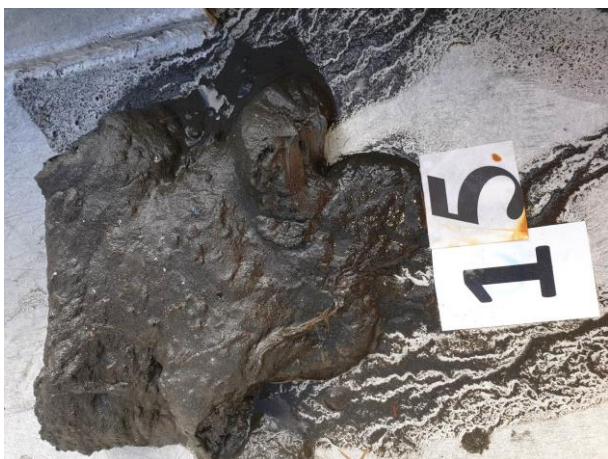
Figur 20: Bilder som viser sedimentet fra stasjon 15 før og etter siling. Sedimentet besto av leire, silt og sand. Foto: Aqua Kompetanse AS.
