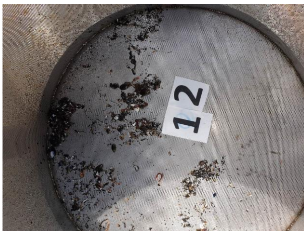
Figur 17: Bilder som viser sedimentet fra stasjon 12 før og etter siling. Sedimentet besto av leire, silt og sand. Det ble registrert fôrrester i denne prøven. Foto: Aqua Kompetanse AS.
