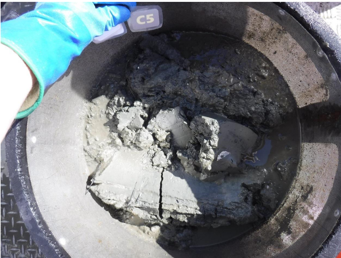
Figur A-4: Bilde av sedimentet ved C5. Sedimentet besto av leire, sand, og skjellsand. Prøven hadde en pelittandel på 94,5% (se kjemirapport i Vedlegg C ). Foto: Aqua Kompetanse AS.
