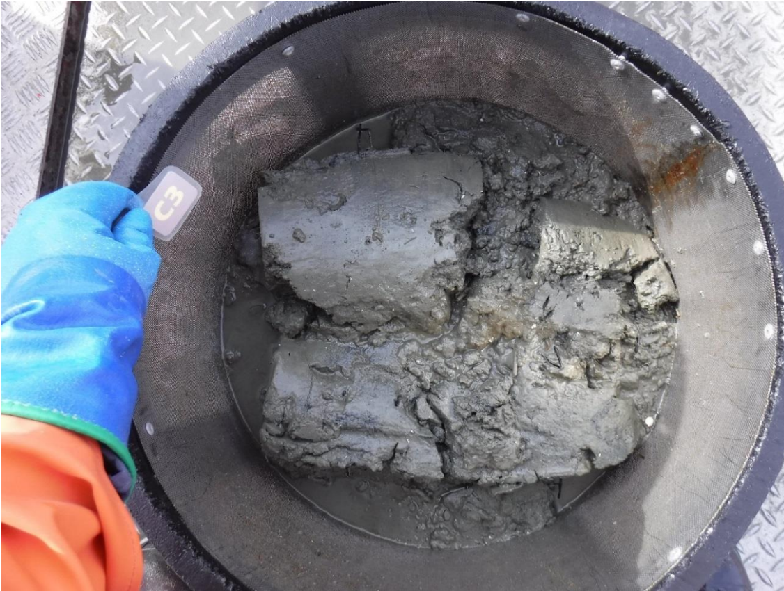
Figur A-3: Bilde av sedimentet ved C3. Sedimentet besto av leire, sand og skjellsand. Det ble ikke utført kjemianalyser ved denne stasjonen. Foto: Aqua Kompetanse AS.
