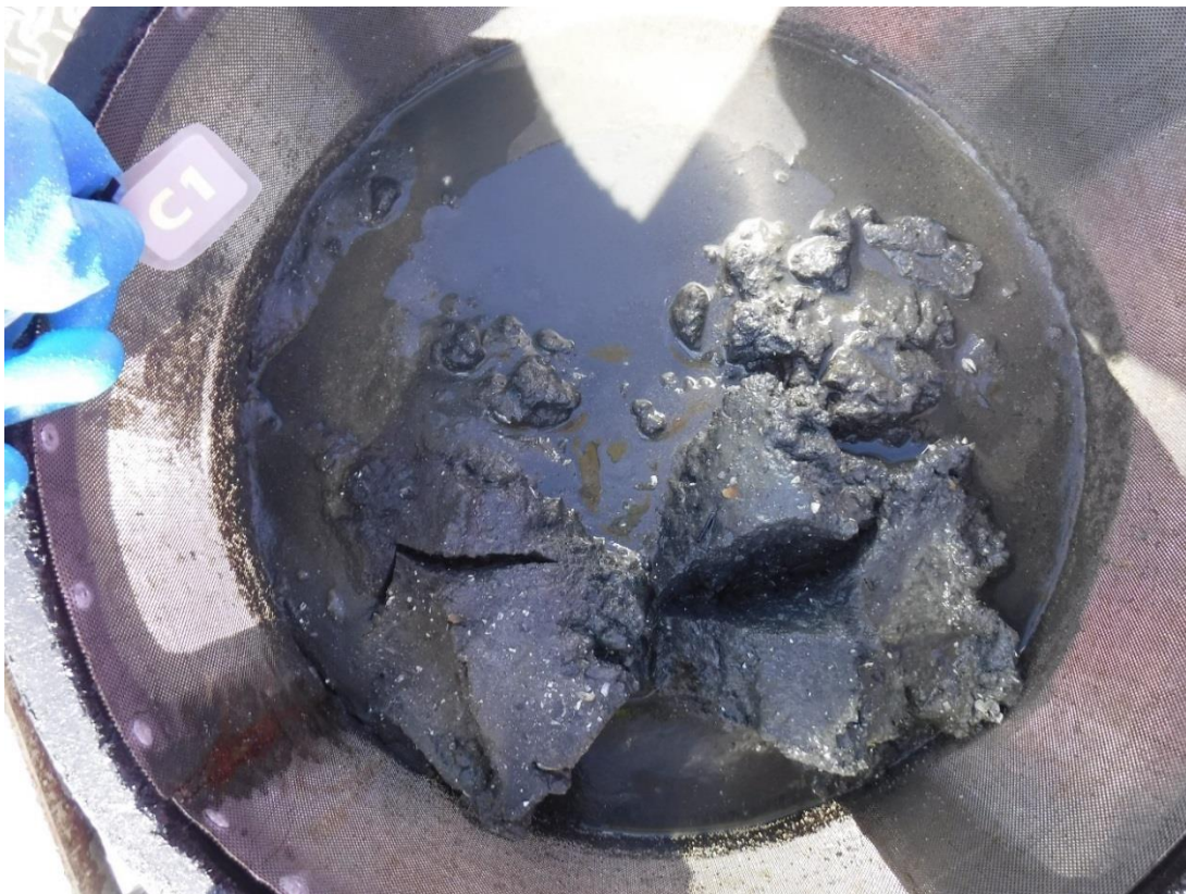
Figur A-1: Bilde av sedimentet ved C1. Sedimentet besto av sand, skjellsand og grus. Prøven hadde en pelittandel på 74,0% (se kjemirapport i Vedlegg C ). Foto: Aqua Kompetanse AS.
