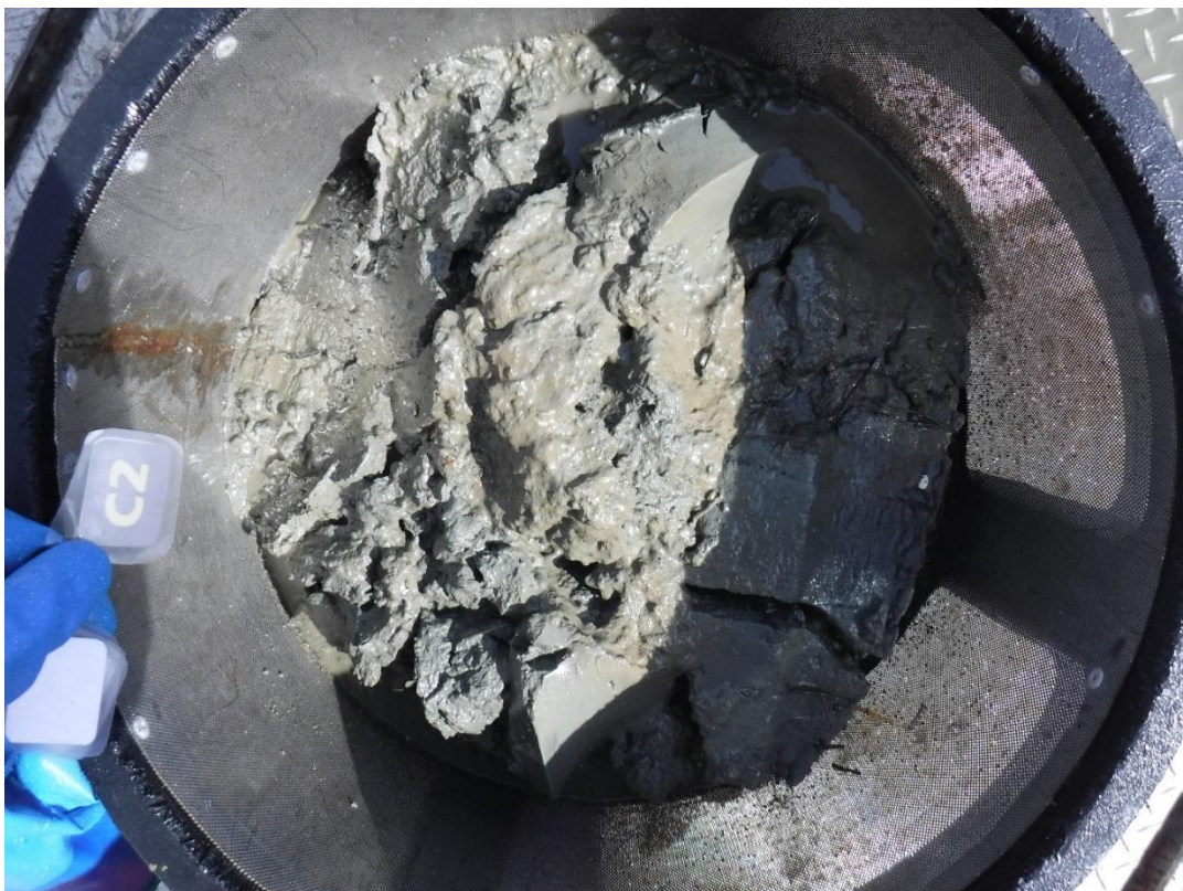
Figur A-2: Bilde av sedimentet ved C2. Sedimentet besto av leire, sand og skjellsand. Prøven hadde en pelittandel på 96,8% (se kjemirapport i Vedlegg C ). Foto: Aqua Kompetanse AS.
