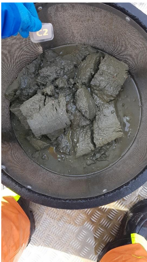
Figur A-2: Bilde av sedimentet ved C2. Sedimentet besto av sand, leire og skjellsand. Prøven hadde en pelittandel på 56,0% (se Eurofins rapport i Vedlegg C ). Foto: Aqua Kompetanse AS.
