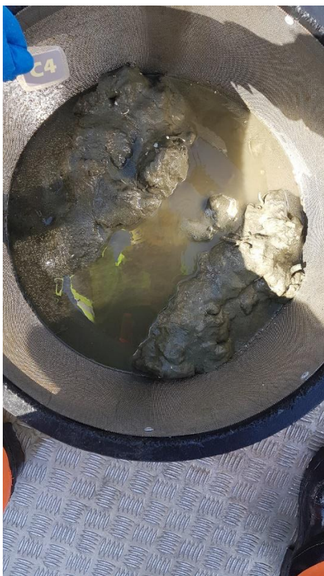
Figur A-4: Bilde av sedimentet ved C4. Sedimentet besto av sand og skjellsand. Prøven hadde en pelittandel på 48,4% (se Eurofins rapport i Vedlegg C ). Foto: Aqua Kompetanse AS.
