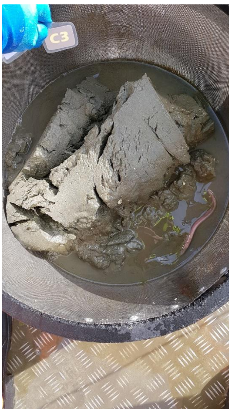
Figur A-3: Bilde av sedimentet ved C3. Sedimentet besto av sand, leire og skjellsand. Prøven hadde en pelittandel på 64,5% (se Eurofins rapport i Vedlegg C ). Foto: Aqua Kompetanse AS.
