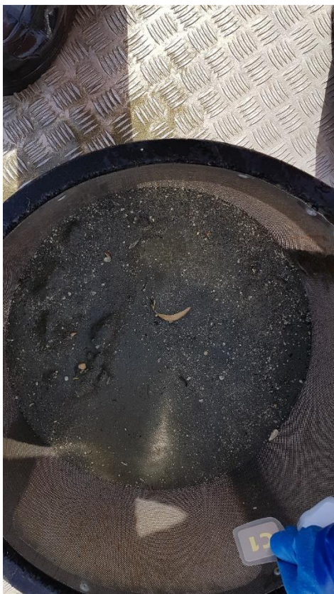
Figur A-1: Bilde av sedimentet ved C1. Sedimentet besto av sand og skjellsand. Prøven hadde en pelittandel på 43,6% (se Eurofins rapport i Vedlegg C ). Foto: Aqua Kompetanse AS.
